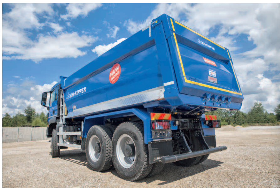
W 2019 r. najpopularniejszym produktem KH-kipper była zabudowa tylnosypowa half-pipe W1U do przewozu materiałów sypkich i asfaltu
