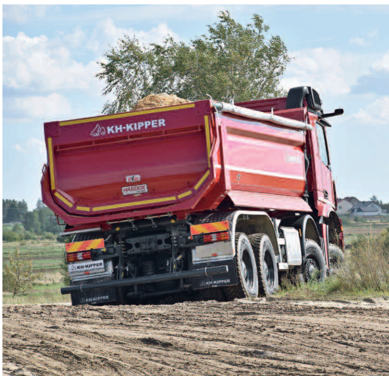
W 2019 r. najpopularniejszym produktem KH-kipper była zabudowa tylnosypowa half-pipe W1U do przewozu materiałów sypkich i asfaltu
