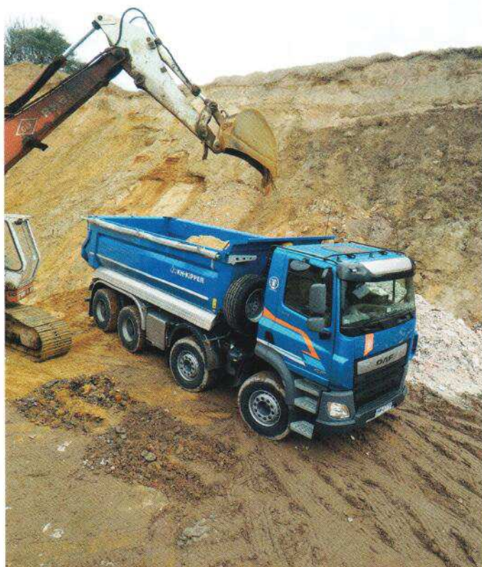
Testowany przez nas samochód z typoszeregu CF 8x4 skonstruowany jest wedle kanonów obowiązujących w budowlance: krótka kabina, mocny silnik i pojemna zabudowa. Przy około 6 metrach długości i niemal 1,5 m wysokości burt, wywrotka ma ponad 19 m 3 objętości.
