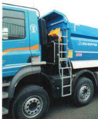
Na kabine zastosowano stopnie i relingi służące do kontroli załadunku muldy. Przednia drabinka na wywrotce jest dobrze przemyślana, po zapięciu nie dzwoni, a rozłożona, jest wygodna do wchodzenia. Niestety, nie można powiedzieć tego samego o tylnej.
