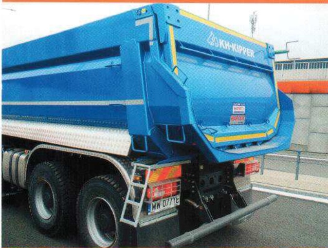
Podłogę muldy wykonano typowo z 7-milimetrowej stali HARDOX 450 o podwyższonej odporności na ścieranie, a burtę z 5-milimetrowych blach ze stali STRENX 700. Obydwa stopy to produkty renomowanych hut szwedzkiego koncernu SSAB.
