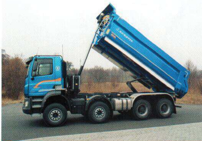
W testowanej zabudowie zamontowano stabilizowany siłownik Hyva Alfa z krótkim kielichem. Przy takiej długości muldy koniecznym stało się wykorzystanie stabilizatora nożycowego, usztywniającego bocznie wywrot w pozycji uniesionej.
