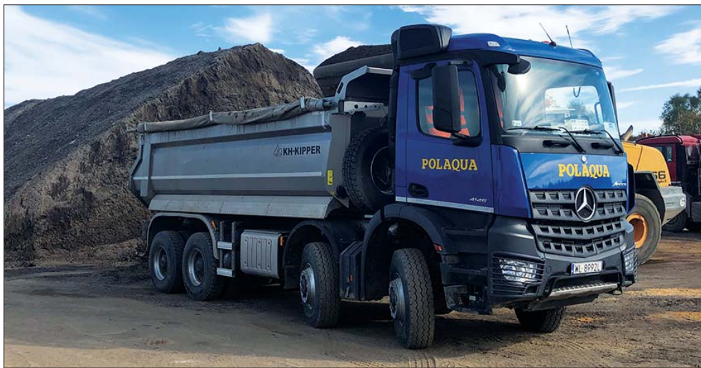
W porównaniu ze standardowymi wywrotkami z uźebrowaniem bocznym zabudowa W1U ma mniejszą masę własną. Jest to możliwe dzięki zastosowaniu giętych burt wykonanych z wysokojakościowych stali trudnościeralnych
