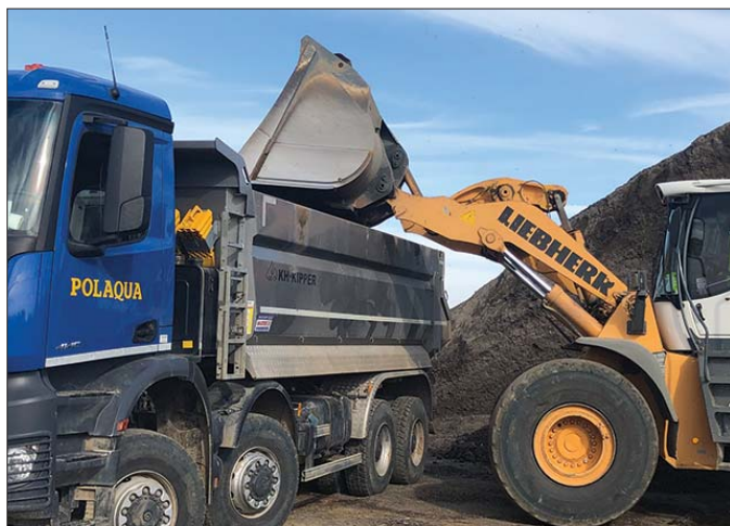
Skrzynię wykonano z wysokiej jakości stali trudnościeralnej, co zwiększa odporność na korozję. Nawet jeśli wierzchnia powłoka zostanie uszkodzona, rdza nie wnika do wewnątrz
