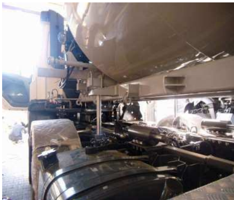
Rys. 52. Zabudowa na siłownikach
