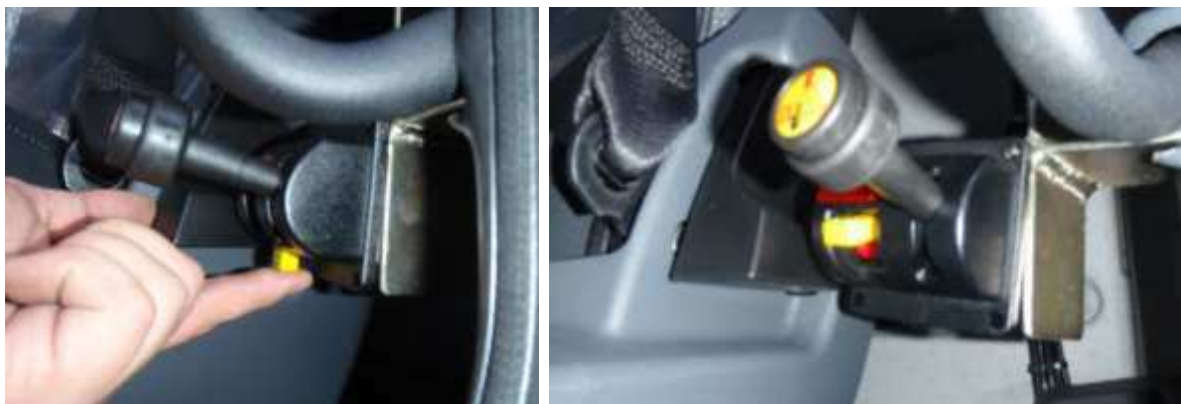
Rys. 14. Otwieranie burty włącznikiem zintegrowanym ze sterownikiem podnoszenia skrzyni
