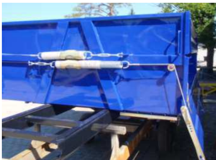
Rys. 24. Przykładowy system wspomagania sprężynowego burt bocznych
