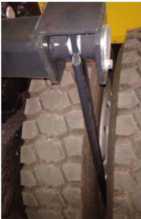
Rys. 45. Tyłne osie z zamontowanymi ostrzami wyrzucającymi kamienie pomiędzy kół.
