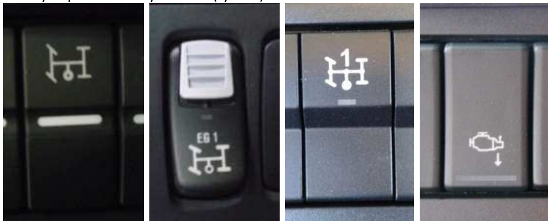
Rys. 10. Przykładowe włączniki i symbole przystawki odbioru mocy
