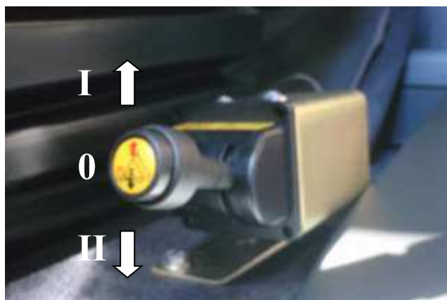
Rys. 17. Pneumatyczny zawór sterujący podnoszeniem i opuszczaniem skrzyni: „I” - podnoszenie skrzyni; „0” - pozycja neutralna; „II” - opuszczanie skrzyni
