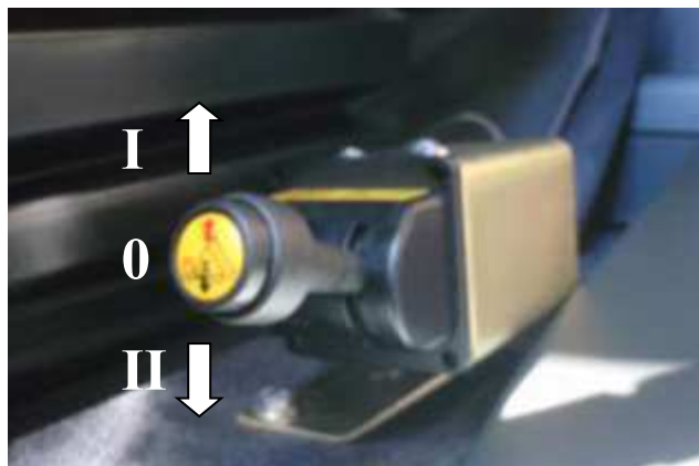
Rys. 25. Pneumatyczny zawór sterujący podnoszeniem i opuszczaniem skrzyni „I” - podnoszenie skrzyni; „0” - pozycja neutralna; „II” - opuszczanie skrzyni
