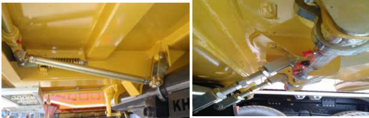
Rys. 11. Przykładowe cięgna otwierania/zamykania burty tylnej
