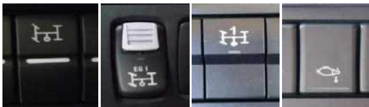
Figure 8. Exemples des interrupteurs et symboles de prise de force
