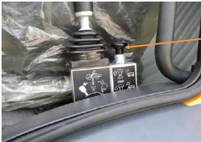
Figure 25. Combinateur du bord hydraulique, interrupteur en position neutre « STOP ».
