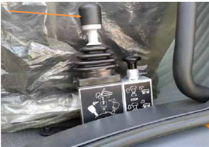
Figure 28. Combinateur du basculement, levier en position neutre.
