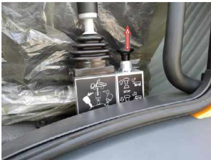
Figure 26. Combinateur du bord hydraulique, ouverture.
