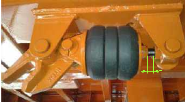
Figure 56. Verrou Hyfix – exemple de fixation
