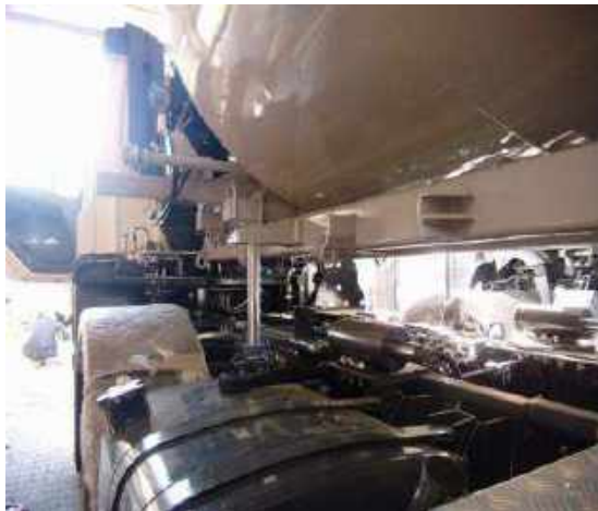
Figure 63. Carrosserie sur les servomoteurs
