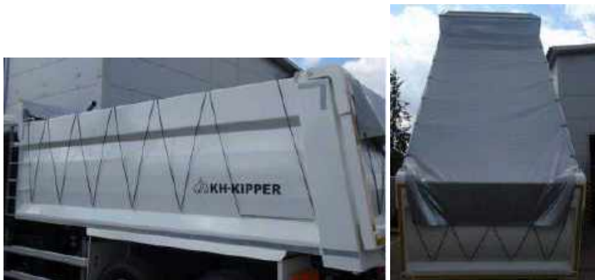
Figure 39. Installation correcte de la bâche
