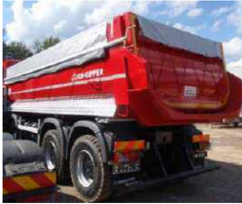
Figure 42. Installation correcte de la bâche
