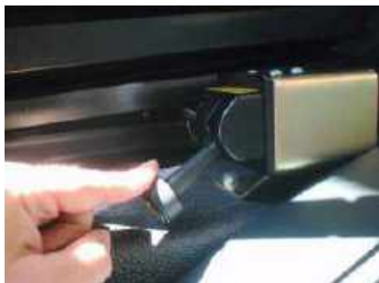
Figure 24. La vanne pneumatique de commande de levage et de descente de la benne: a) l'abaissement de la benne, b) position neutre
