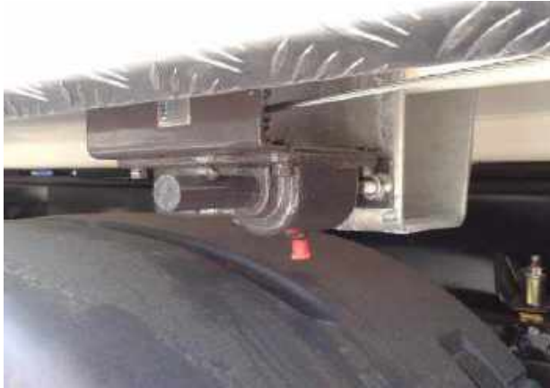
Figure 34. Treuil de la roue de remplacement
