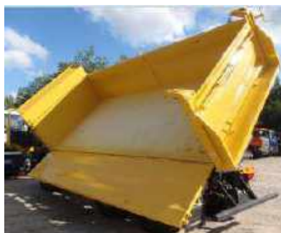
Figure 18. Le bord hydraulique ouvert pour le déchargement des matériaux en vrac
