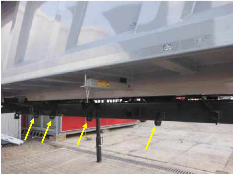
Figure 60. Douilles de châssis accessoire de la carrosserie pour le blocage sur le châssis
