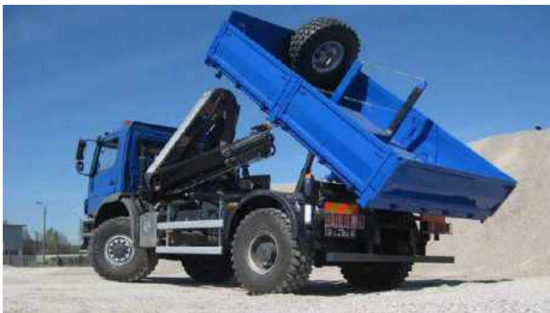
Figure 19. Exemple de la carrosserie de type W3F
