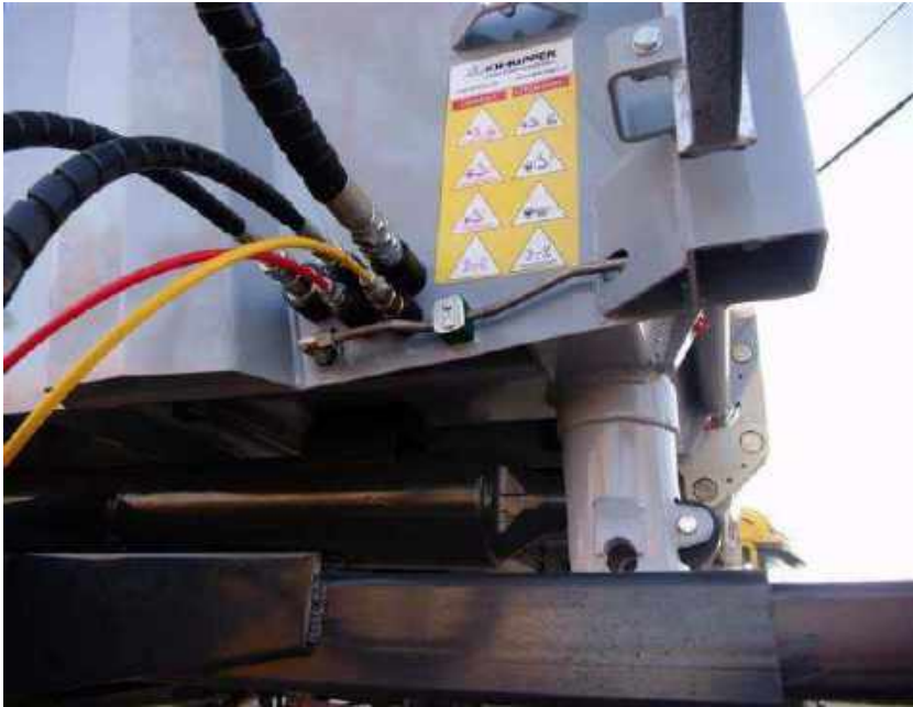
Figure 67. Prises de stationnement des conduits hydrauliques et pneumatiques déconnectés.
