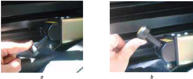
Figure 13. La vanne pneumatique commande le bord hydraulique: a) ouverture du bord, b) fermeture du bord
