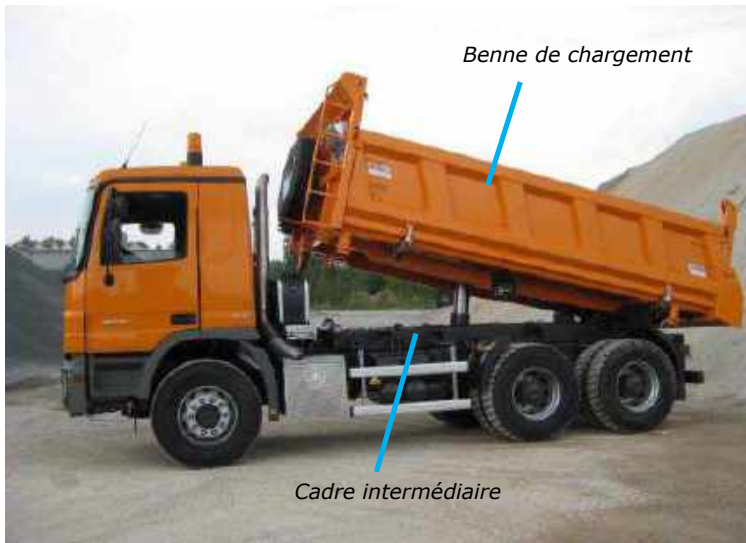
Figure 1. Exemple de construction - benne à basculement
