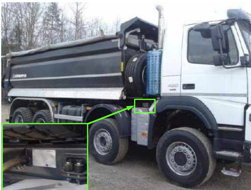
Figure 4b. Exemples de l'emplacement de la plaque signalétique
