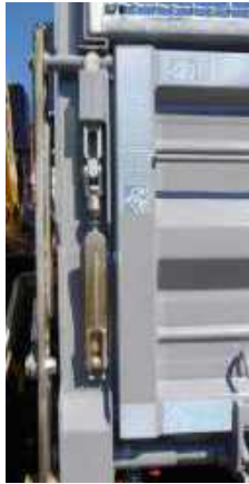
Figure 21. Exemple de fermeture des bords latéraux: a) position fermée, b) position ouverte
