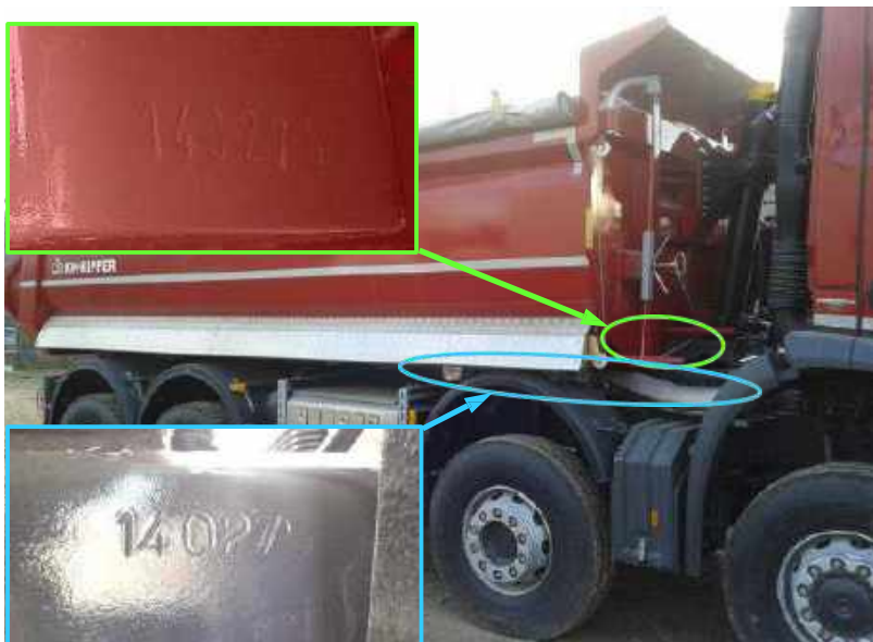
Figure 5. Lieu de l'emplacement d'un exemple du numéro de lot sur la benne de chargement et dans le cadre intermédiaire
