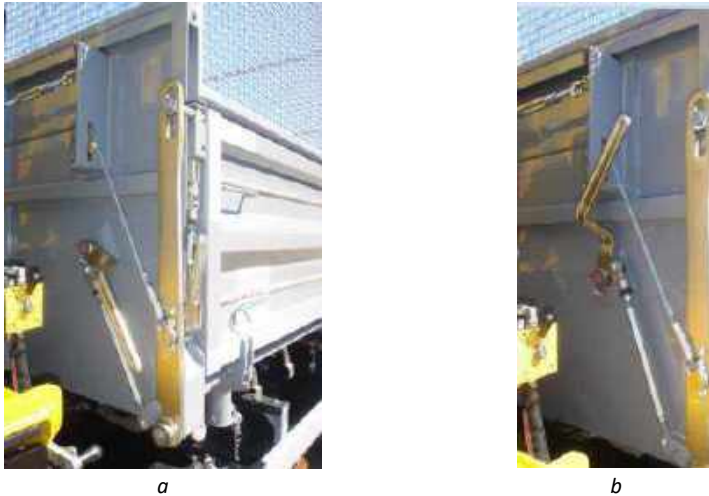
Figure 20. Le levier d'ouverture/fermeture du bord latéral: a) position fermée, b) position ouverte
