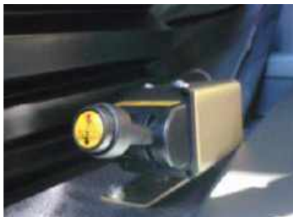
Figure 24. La vanne pneumatique de commande de levage et de descente de la benne: a) l'abaissement de la benne, b) position neutre
