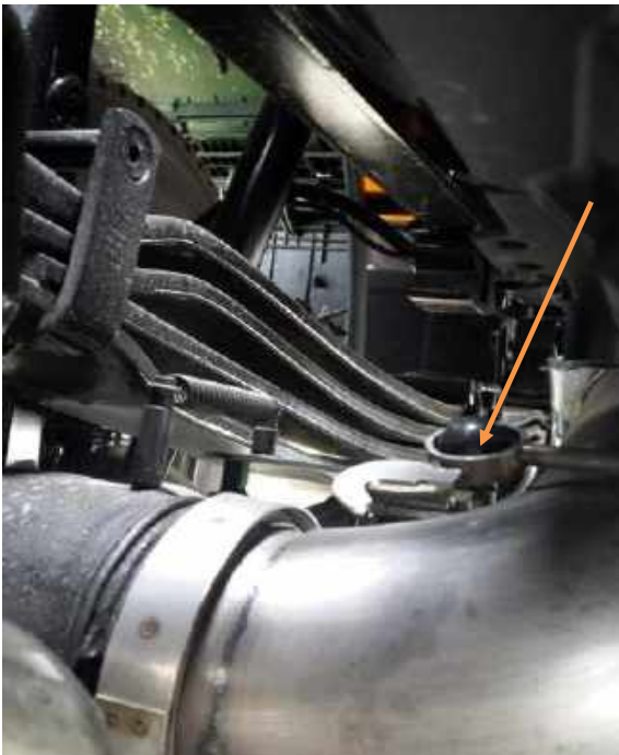
Figure 55. Rallonge installé sur le levier de la soupape.
