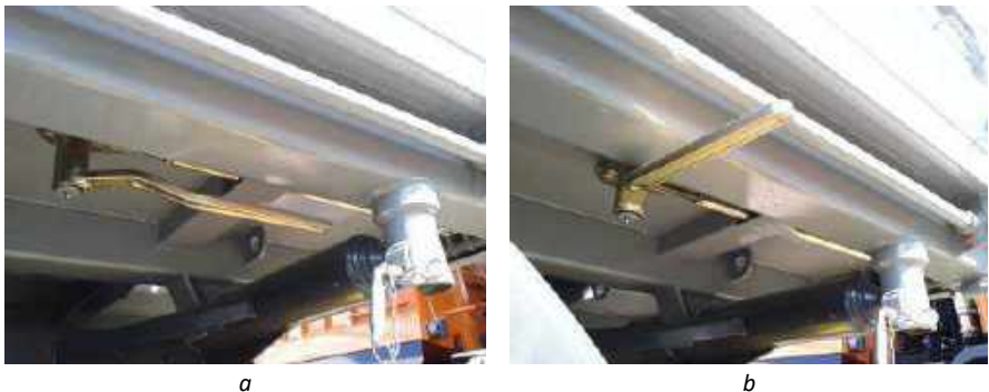
Figure 10. Le levier d'ouverture/fermeture des crochets du bord arrière: a) position fermée, b) position ouverte
