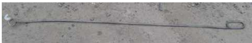
Figure 52. Rallonge pour le service de la soupape d'échappement.
