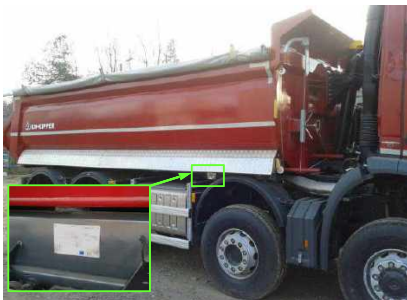
Figure 4a. Exemples de l'emplacement de la plaque signalétique
