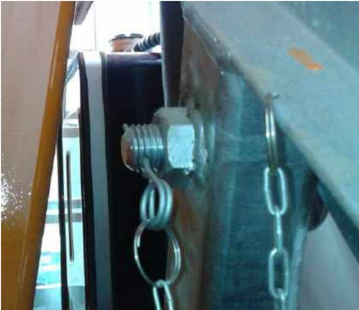
Figure 35. Le treuil de la roue de secours et la goupille de sécurisation.
