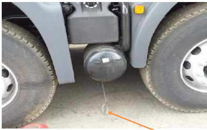
Figure 53. Localisation de la soupape de gaz d'échappement au-dessus du cadre de chassie, la rallonge apparente.
