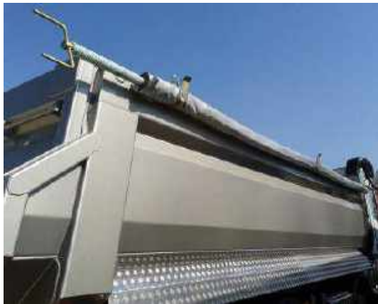
Figure 37. Bâche: a) pliée sur la paroi avant, b) pliée sur le bord latéral
