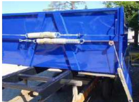
Figure 22. Exemples des systèmes de support à ressort des bords latéraux
