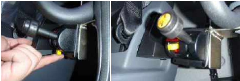
Figure 12. L'ouverture du bord avec l'interrupteur intégré avec le contrôleur du relèvement de la benne
