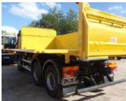
Figure 18. Le bord hydraulique ouvert pour le déchargement des matériaux en vrac
