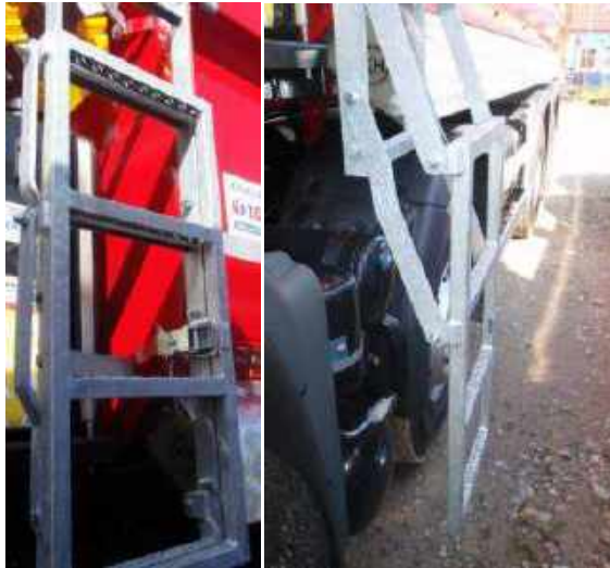
Figure 38. Échelle sur la paroi avant
