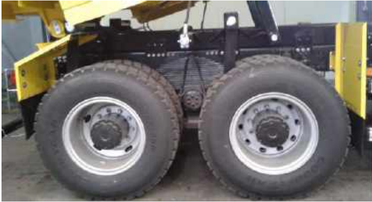
Figure 57. Essieux arrière avec des lames montées jetant des pierres d'entre les roues.
