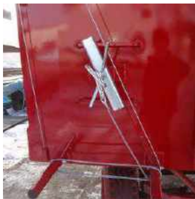
Figure 36. Exemples de sécurisation de la corde de la roue de secours
