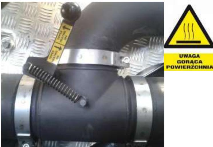
Рис. 42. Распределительный клапан выхлопных газов.
