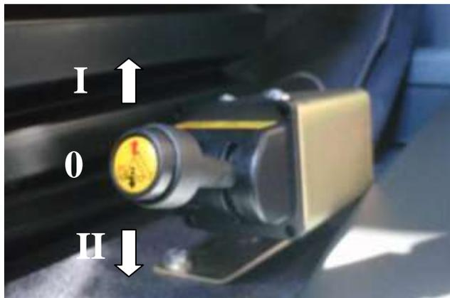
Рис. 17. Пневматический клапан, управляющий подъемом и опусканием кузова:
