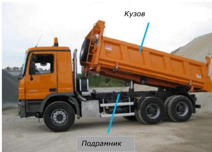
Рис. 1 Пример надстройки - самосвал
