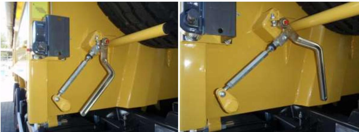
Рис. 13. Рычаг открытия / закрытия крюков бокового борта: а) закрытая позиция, б) открытая позиция.
