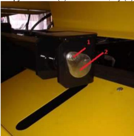
2. Вставить камнеотбойник снизу в гнездо. В задней части через щель в крыле. Обеспечить их крепежным болтом.
