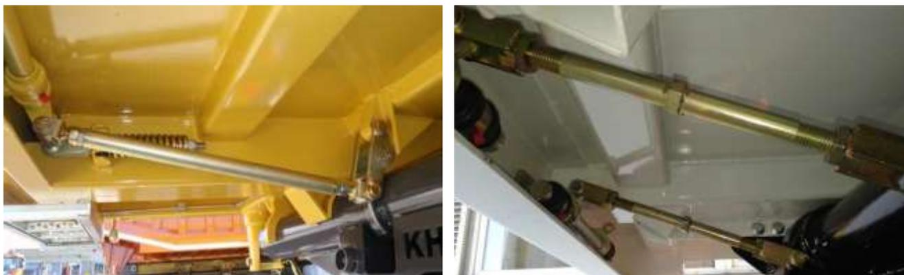
Рис. 11. Пример соединительной тяги открытия / закрытия заднего борта.
