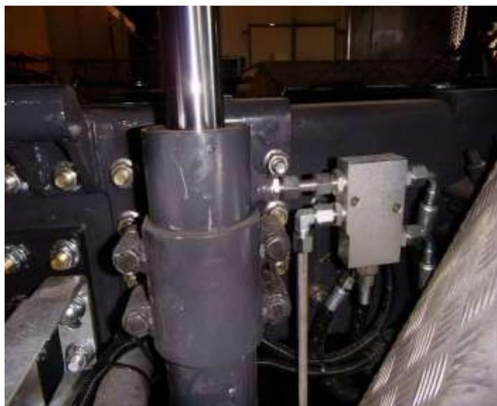
Рис. 50. Цилиндр подъема/опускания
