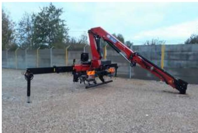
Рис. 46 Гидравлический автомобильный кран (HDS)
