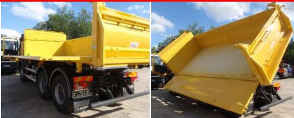
Рис. 20. Гидравлический борт, открытый для разгрузки сыпучих материалов.
