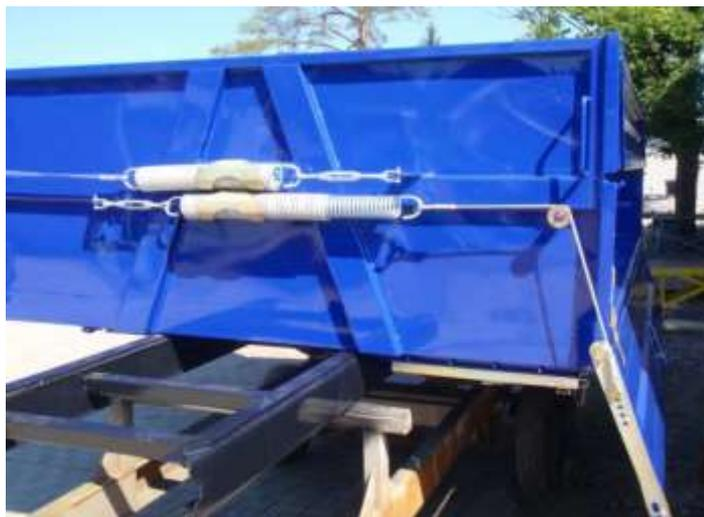
Рис. 24. Пример системы пружинной поддержки боковых бортов.
