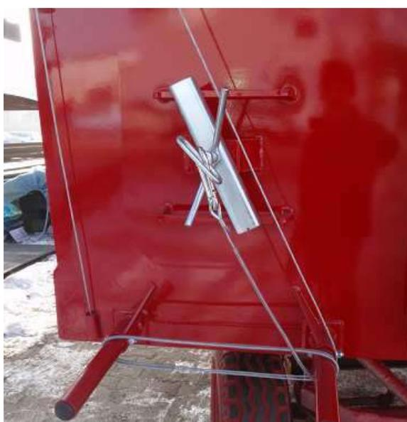
Рис. 31. Пример предохранения троса запасного колеса.
