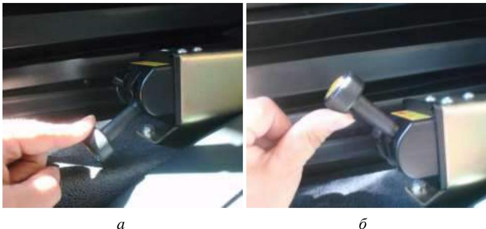
Рис.15. Пневматический клапан, управляющий гидравлическим бортом: а) открытие борта, б) закрытие борта.
