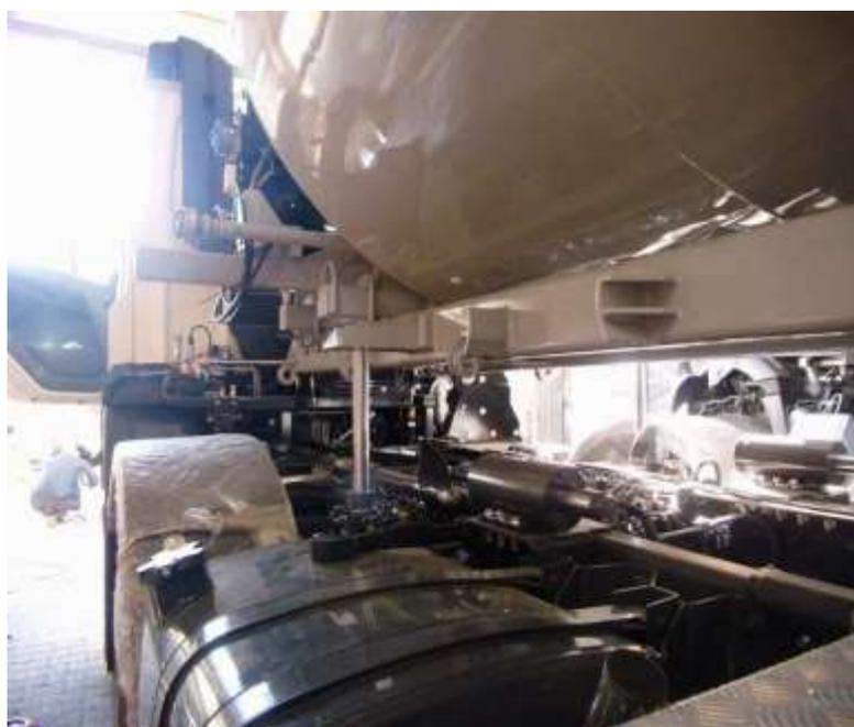
Рис. 52. Надстройка на цилиндрах
