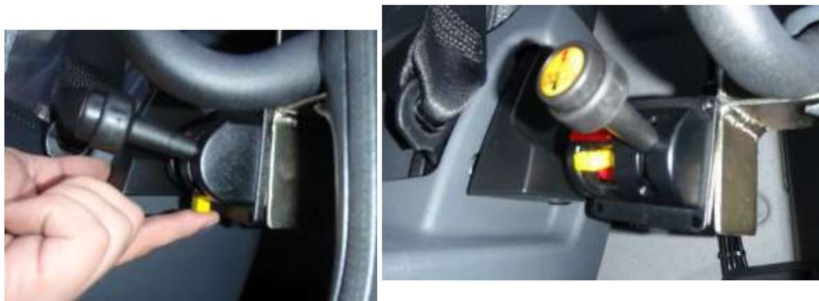
Рис. 14. Открытие борта включателем, интегрированным с управлением подъема кузова.
