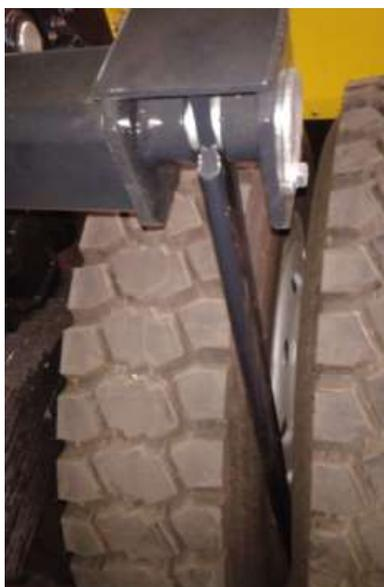
Рис. 45. Задние оси с отбойниками, выбрасывающими камни из-под колес.
