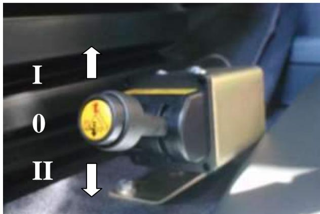
Рис. 19. Пневматический клапан, управляющий подъемом и опусканием кузова „I” – подъем кузова; „0” – нейтральная позиция, „II” – опускание кузова.
