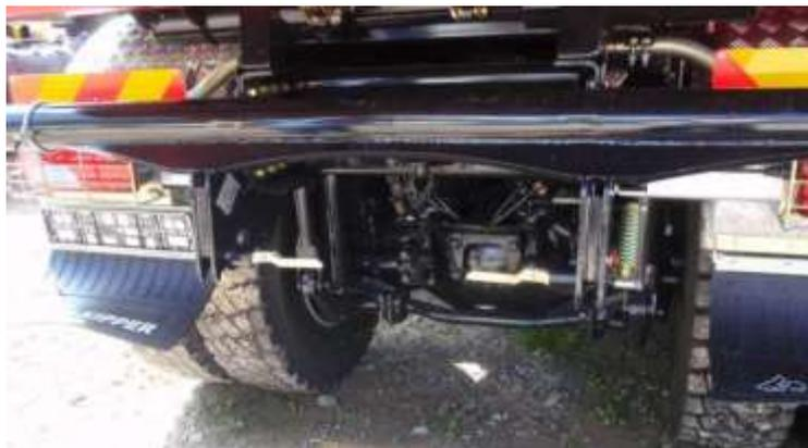
После опускания бумера следует предохранить его шкворнями (рычаги шкворней в вертикальной позиции).
