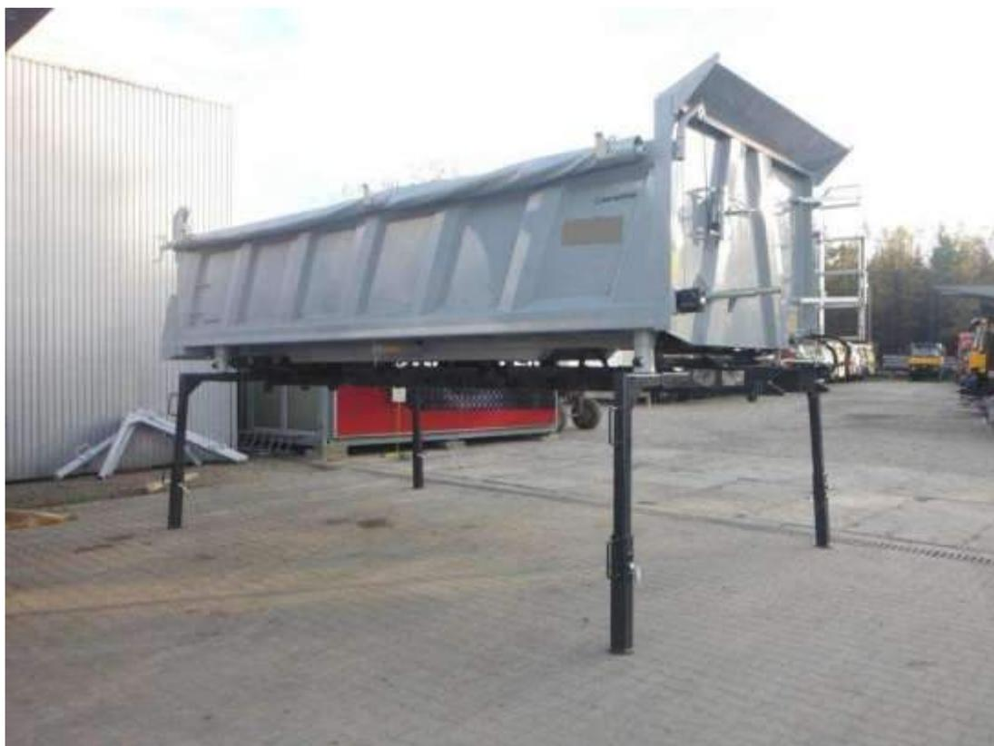
Рис. 48. Кузов самосвала на боковых опорах.
