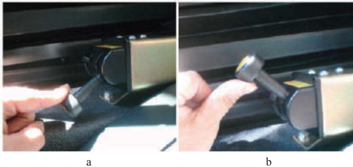
Slika 10. Pneumatski kontrolni ventil za hidraulične stranice: a) otvaranje stranice, b) zatvaranje stranice.
