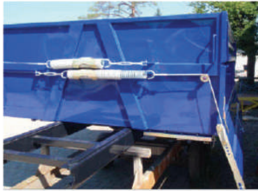
Slika 19. Primer mehanizma sa oprugom za bočne stranice.
