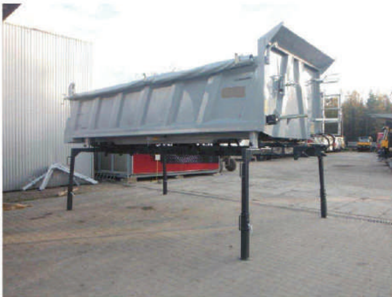
Slika 40. Tovarni sanduk kipera na bočnim postoljima.
