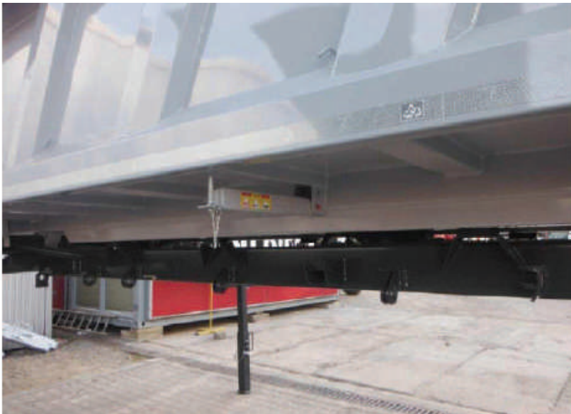
Slika 41. Čaure pomoćnog okvira karoserije za zabavljanje na šasijsu.
