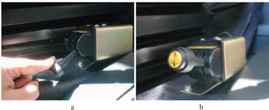
Slika 21. Pneumatski ventil koji kontrolise podizanje i spuštanje tovarnog sanduka: a) spuštanje tovarnog sanduka, b) neutralan položaj.
