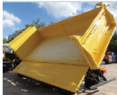
Slika 15. Hidraulična stranica otvorena za potrebe istovarivanja rastresitih materijala.
