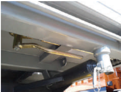
Slika 7. Poluga za otvaranje / zatvaranje kuka za zadnju stranicu; a) zatvoren položaj, b) otvoren položaj.
