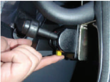
Slika 9. Otvaranje stranice korišćenjem prekidača integrisanog u kontroler za podizanje tovarnog sanduka.
