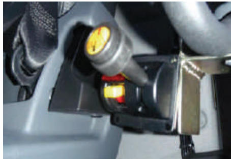
Slika 9. Otvaranje stranice korišćenjem prekidača integrisanog u kontroler za podizanje tovarnog sanduka.
