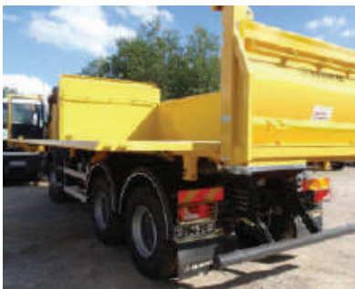
Slika 15. Hidraulična stranica otvorena za potrebe istovarivanja rastresitih materijala.
