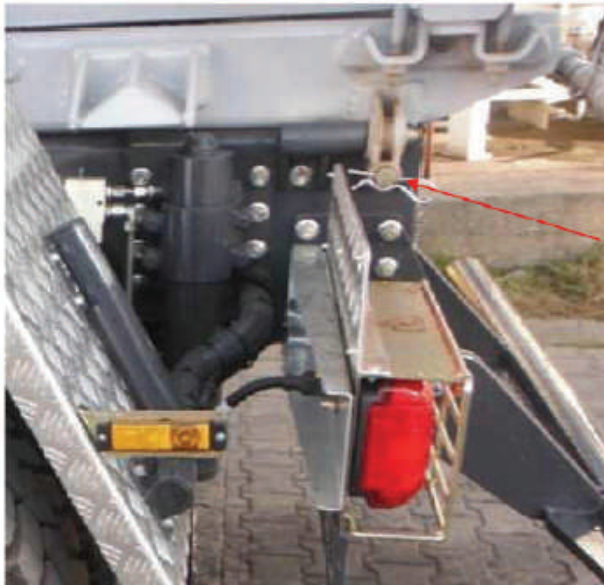
Slika 47. Sigurnosna osovina sa osiguračem. Blokirana karoserija.
