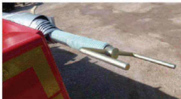
Slika 30. Obrtna ručica za bočno namotavanje cerade
