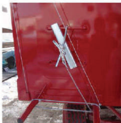
Slika 25. Primer načina za pričvršćenje užeta rezervnog točka.
