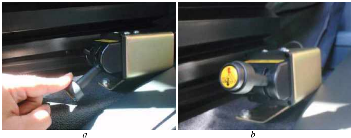
Obr. 24. Pneumatický ventil ovládajúci zdvíhaním a znížením nadstavby: a) zníženie nadstavby, b) neutrálna poloha
