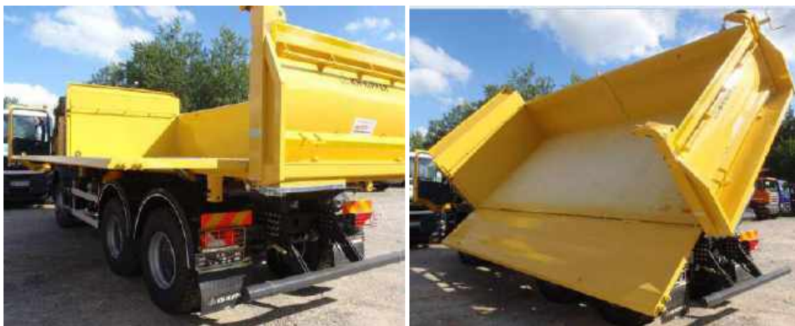
Obr. 18. Hydraulická bočnica otvorená pre vykládku sypkých materiálov
