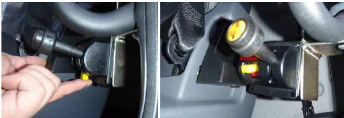
Obr. 12. Otváranie bočnice spínačom integrovaným s ovládačom zdvíhania nadstavby
