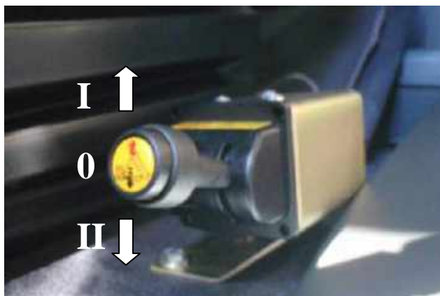
Obr. 23. Pneumatický ventil ovládajúci zdvíhanie a znižovanie nadstavby „I“ - zdvíhanie nadstavby; „0“ - neutrálna poloha; „II“ - znižovanie nadstavby
