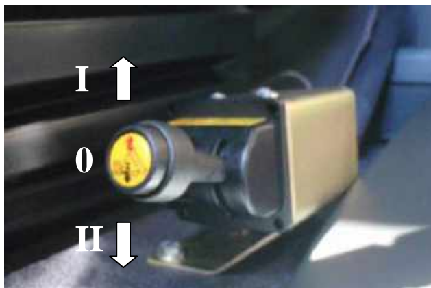
Obr. 15. Pneumatický ventil ovládajúci zdvíhanie a znižovanie nadstavby: „I“ - zdvíhanie nadstavby; „0“ - neutrálna poloha; „II“ - znižovanie nadstavby
