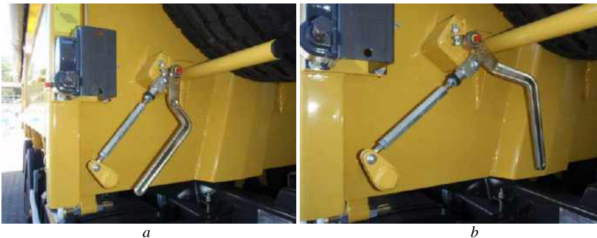
Obr. 11. Páka otvárania/uzatvárania hákov bočnice: a) uzatvorená poloha, b) poloha otvorená
