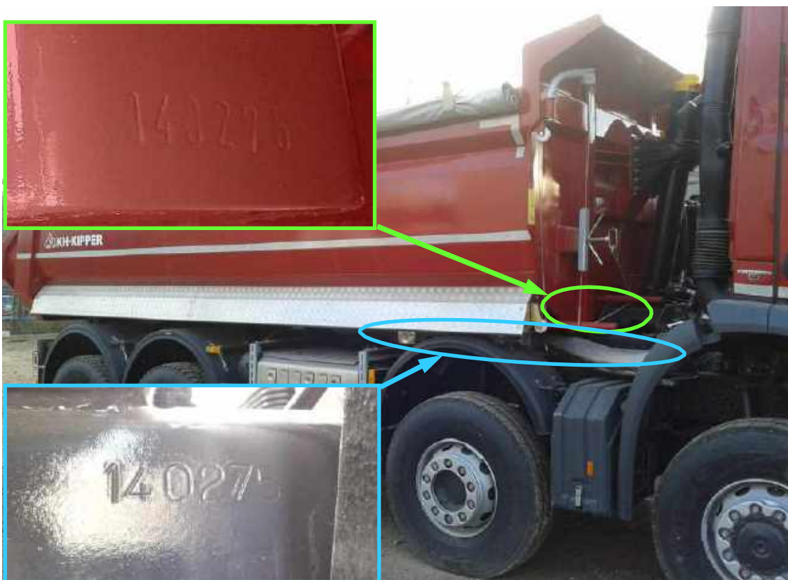
Obr. 5. Príklad umiestnenia vytlačeneho továrenského čísla na nadstavbe a priebežnom ráme.
