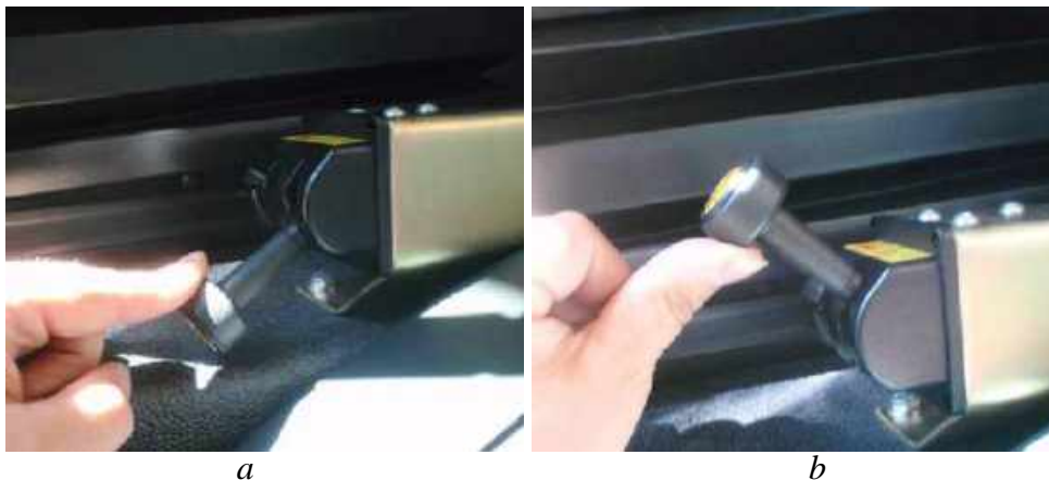
Obr. 13. Pneumatický ovládací ventil hydraulickej bočnice: a) otváranie bočnice, b) uzatváranie bočnice
