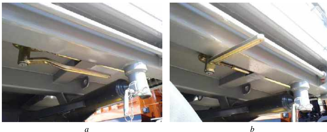
Obr. 10. Páka otvárania/uzatvárania hákov zadnej steny: a) poloha uzavretá, b) poloha otvorená
