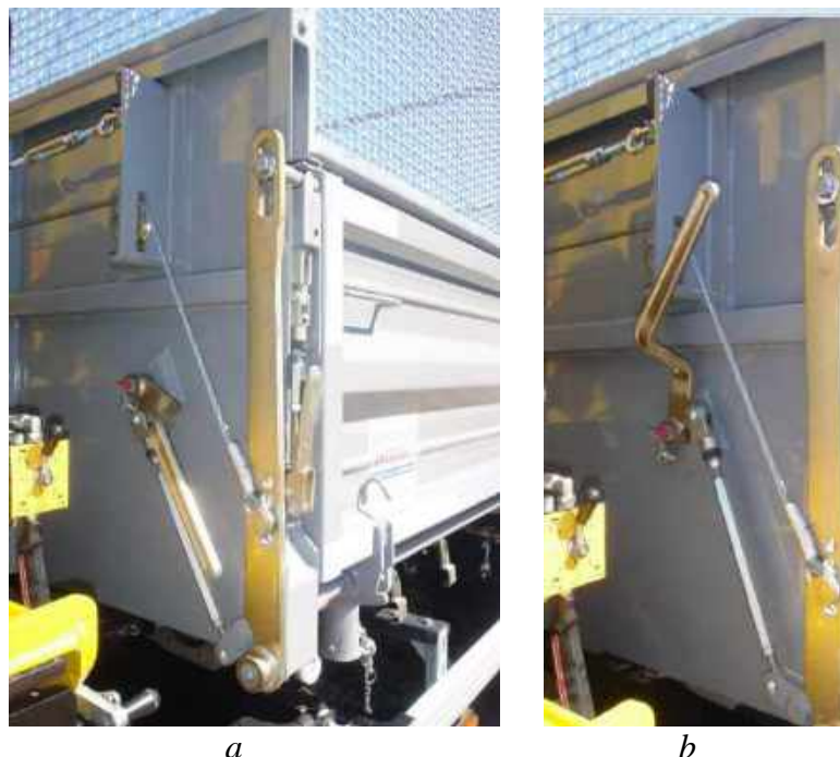
Obr. 20. Páka bočnice: a) zatvorená poloha, b) otvorená poloha
