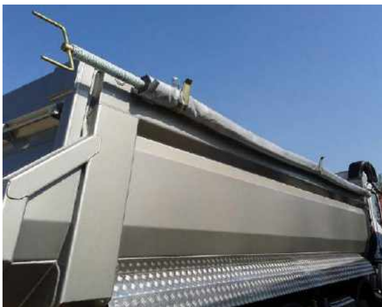
Obr. 30. Plachta: a) zvinutá na prednú stenu, b) zvinutá na bočnici
