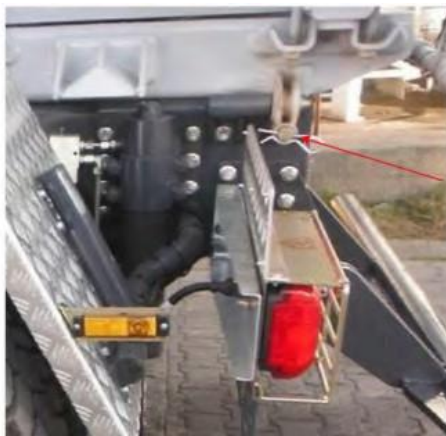
Fig. 47 Bolț de siguranță și știft. Caroserie blocată.
