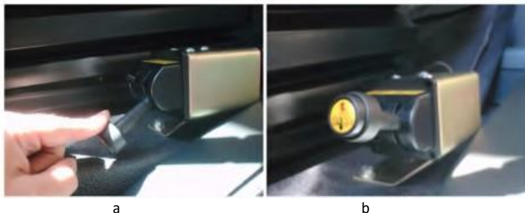
Fig.21 Supapă pneumatică care controlează ridicarea și coborârea benei: a) bena ridicând, b) poziție neutră.
