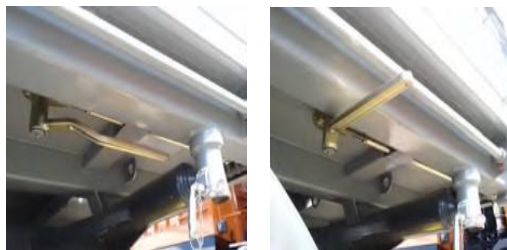
Fig.7 Maneta pentru deschiderea / închiderea blocatorilor panoului din spate: a) poziția închis , b) poziția deschis .
