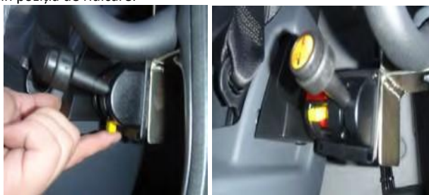
Fig. 9 Deschiderea oblonului cu ajutorul controlerului cu butonul de ridicare a benei integrat.
