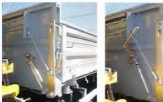
Fig.17 Maneta panoului lateral: a) poziția închis , b) poziția deschis .
