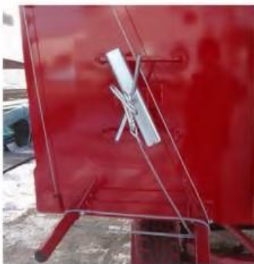
Fig.25 Exemplu de cum se asigură frânhia pentru roata de rezervă
