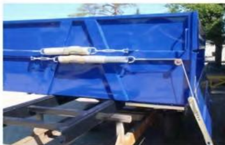
Fig.19 Model de sistem cu direcție acționată prin arcuri pentru obloanele laterale
