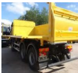
Fig.15 Oblonul hidraulic deschis în scopul descărcării materialelor granulare.
