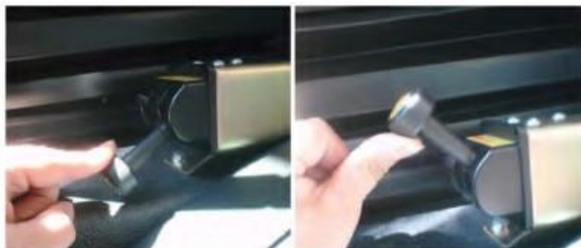
Fig.10 Supapa de control pneumatică pentru panoul hidraulic: a) deschiderea panoului, b) închiderea panoului.
