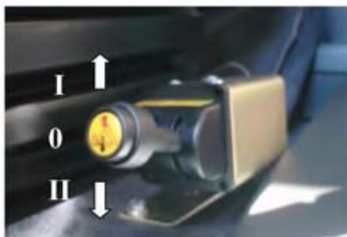
Fig.14 Supapă pneumatică care controlează ridicarea și coborârea benei: I – bena ridicând; 0 – poziție neutră; II – bena coborând.
