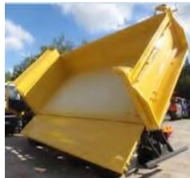
Fig.15 Oblonul hidraulic deschis în scopul descărcării materialelor granulare.
