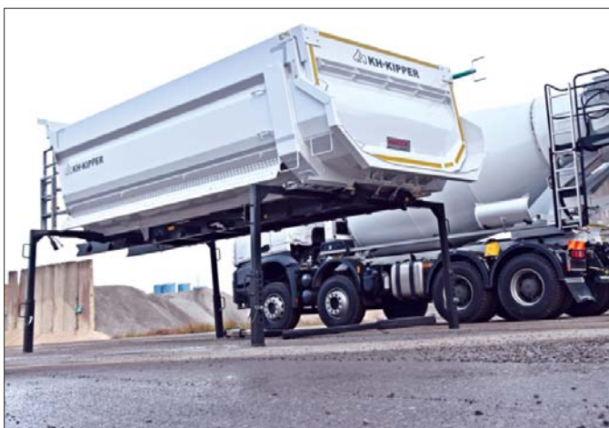
Całość operacji związanych z wymianą zabudowy może wykonać nawet jedna osoba, na przykład kierowcę samochodu, w ciągu zaledwie 10-14 minut
