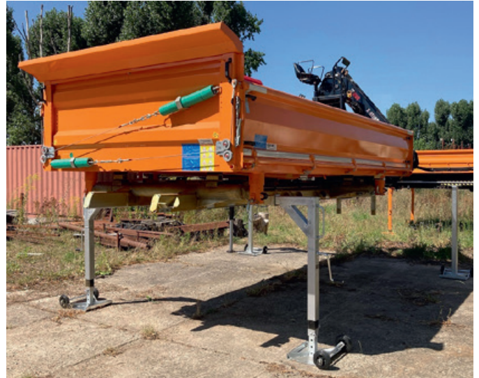
Dobrze zabezpieczone przed korozją nadwozie samowyładowcze KH-KIPPER może przeczekać zimę na podporach nawet w agresywnym otoczeniu soli i solanki składowanych i załadowywanych w bazach drogowców.
