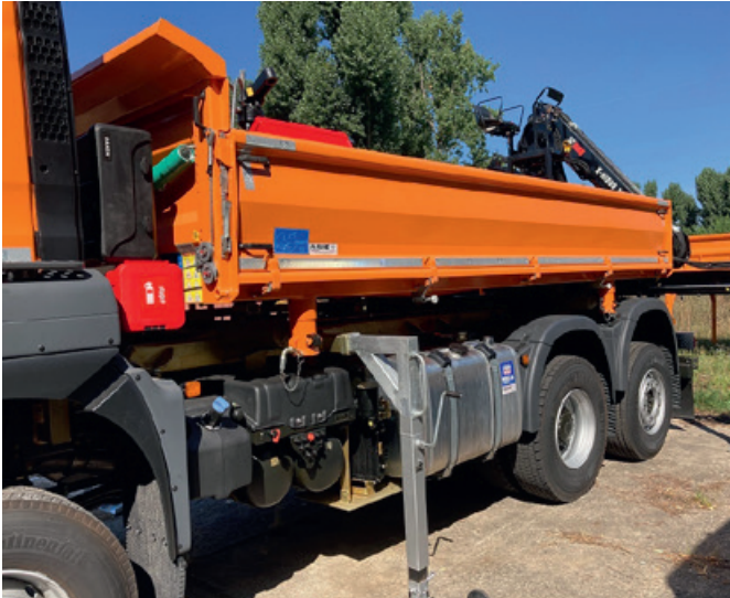
System wykorzystujący do wymiany nadwozi tylko regulację wysokości podwozia na zawieszeniu pneumatycznym i nogi podporowe także sprzyja dużej ładowności.
