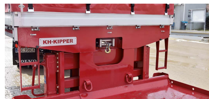
Pod zabudową warsztatową zamontowana jest 9-tonowa wciągarka pozwalająca na załadunek uszkodzonych pojazdów
