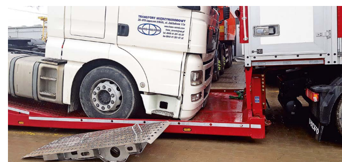
Dzięki zagłębieniom na koła w przedniej części pokładu można przewozić ciągniki siodłowe z bardzo wysokimi kabinami bez przekroczenia skrajni
