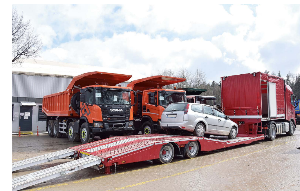
Dzięki swoim wymiarom oraz łagodnym podjazdom naczepa pozwala na przewożenie różnego typu samochodów osobowych, dostawczych, ciężarówek, autobusów oraz maszyn samojezdnych i przyczep
