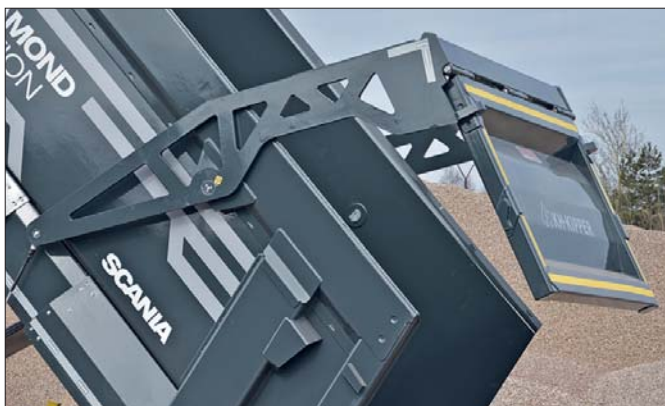
Szeroko otwierana tylna burta zamykana jest za pomocą lin. Uniesiona w tylnej części podłoga zapobiega wysypywaniu się materiału w czasie jazdy po pochyłościach
