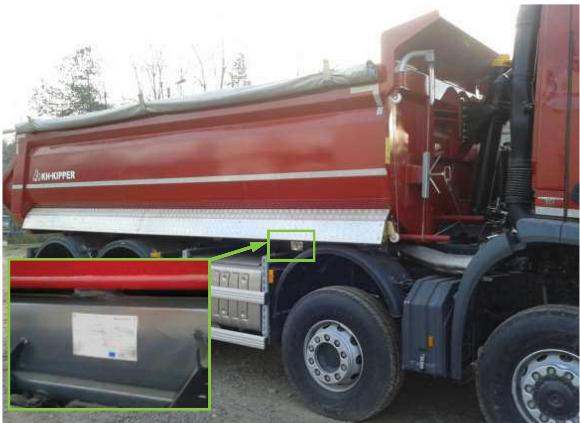
Rys. 4a. Przykładowe miejsce umieszczenia tabliczki znamionowej
