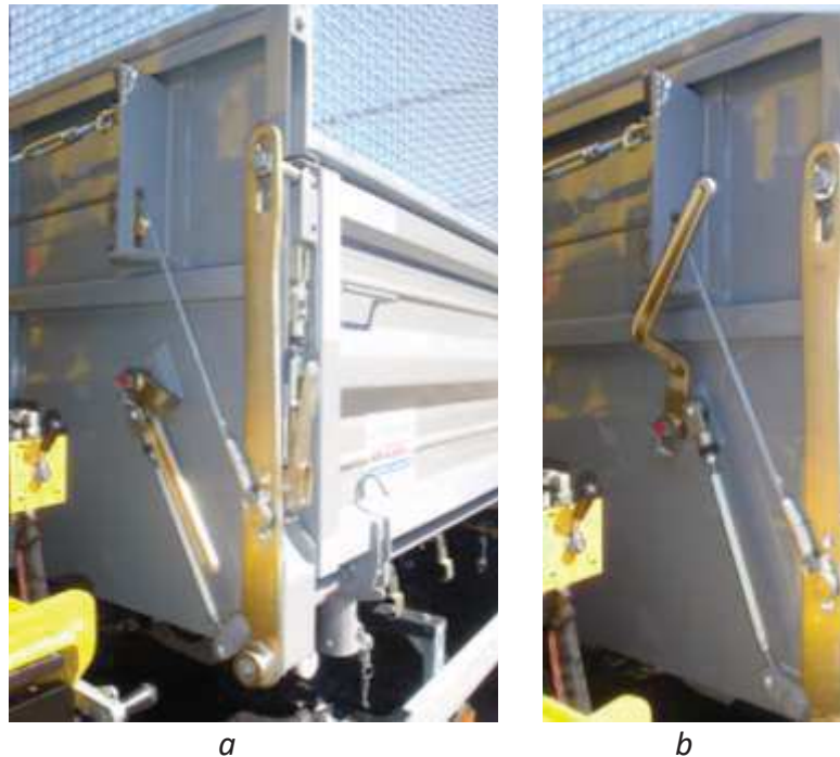
Rys. 22. Dźwignia burty bocznej: a) pozycja zamknięta, b) pozycja otwarta
