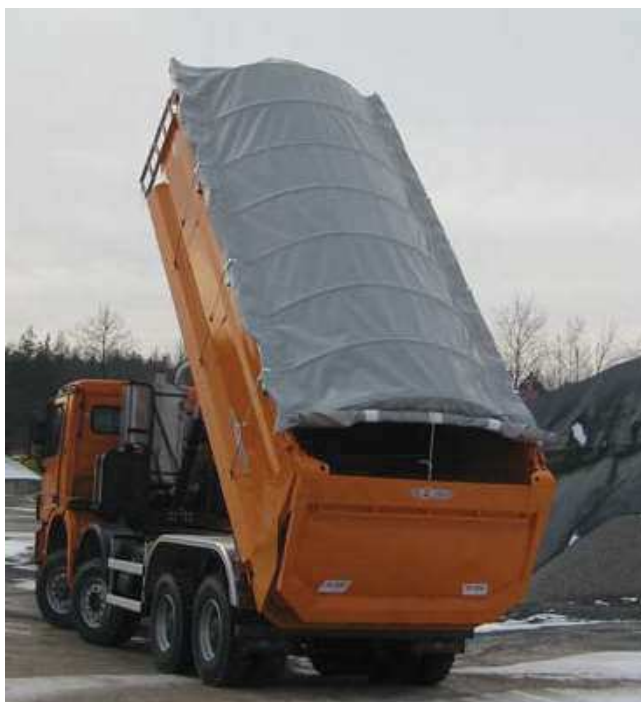
Rys. 38. Automatyczny system plandekowy
