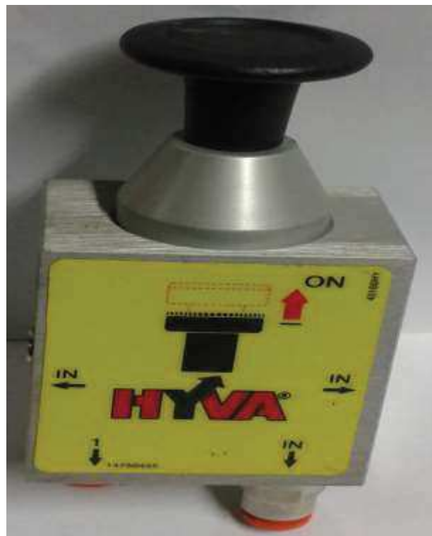
Rys. 8. Przykładowe sterowniki pneumatyczne: a,b) otwierania/zamykania burty hydraulicznej, c) sterownik zaworu 3/2 żuraw/wywrotka lub wywrotka/przyczepa.
