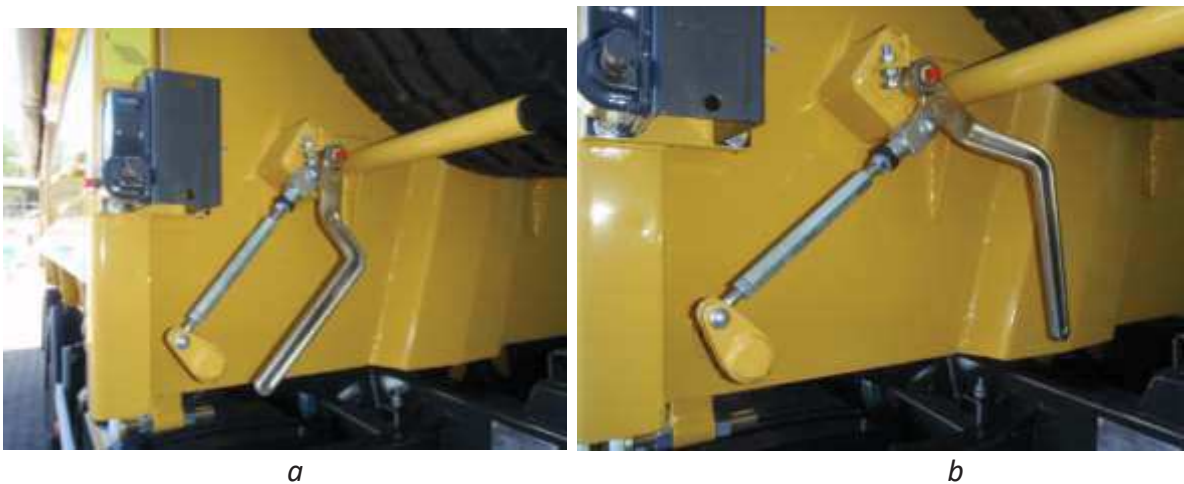
Rys. 13. Dźwignia otwierania/zamykania haków burty bocznej: a) pozycja zamknięta, b) pozycja otwarta
