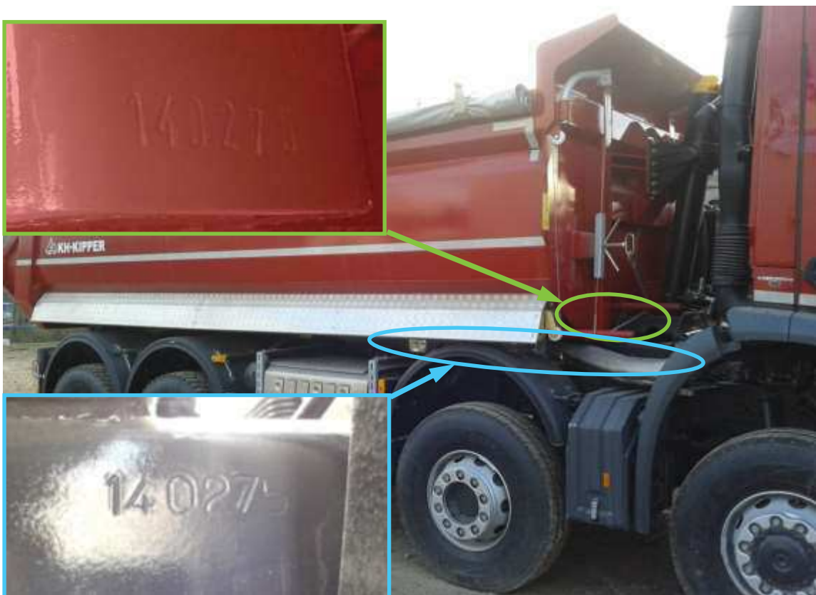
Rys. 5. Miejsce wybitego przykładowego numeru fabrycznego na skrzyni ładunkowej i ramie pośredniej
