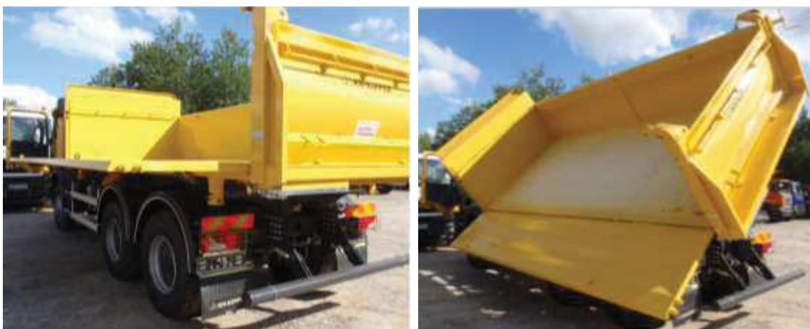
Rys. 20. Burta hydrauliczna otwarta do wyładunku materiałów sypkich
