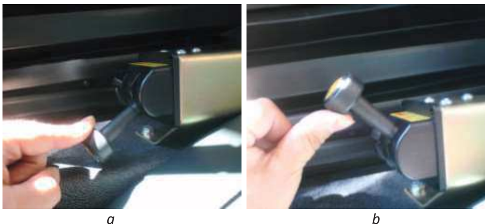
Rys. 15. Pneumatyczny zawór sterujący burtą hydrauliczną: a) otwieranie burty, b) zamykanie burty
