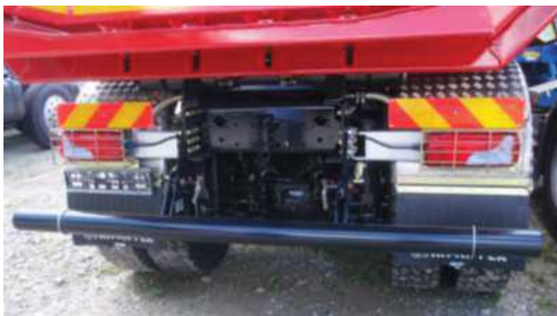
Rys. 41. Zderzak składany w pozycji opuszczonej
