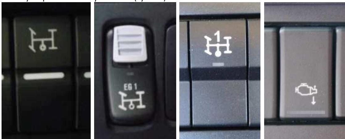
Rys. 10. Przykładowe włączniki i symbole przystawki odbioru mocy
