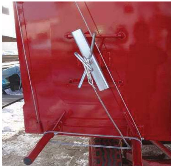
Rys. 31. Przykładowe zabezpieczenie linki koła zapasowego
