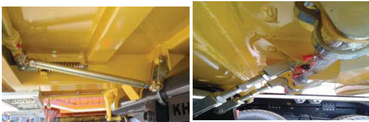
Rys. 11. Przykładowe cięgna otwierania/zamykania burty tylnej
