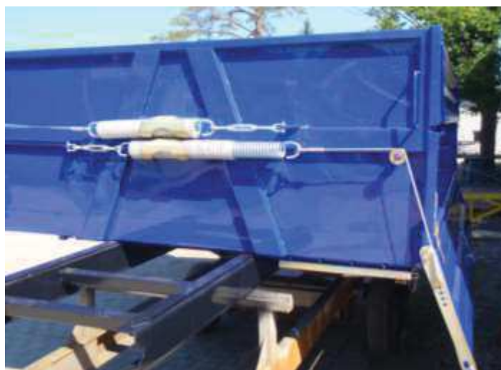
Rys. 24. Przykładowy system wspomagania sprężynowego burt bocznych
