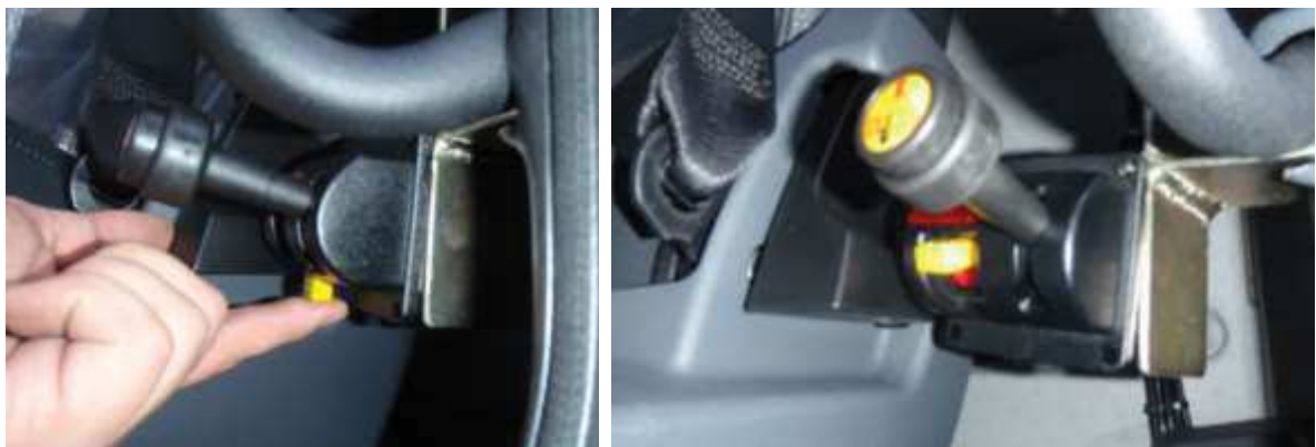
Rys. 14. Otwieranie burty włącznikiem zintegrowanym ze sterownikiem podnoszenia skrzyni
