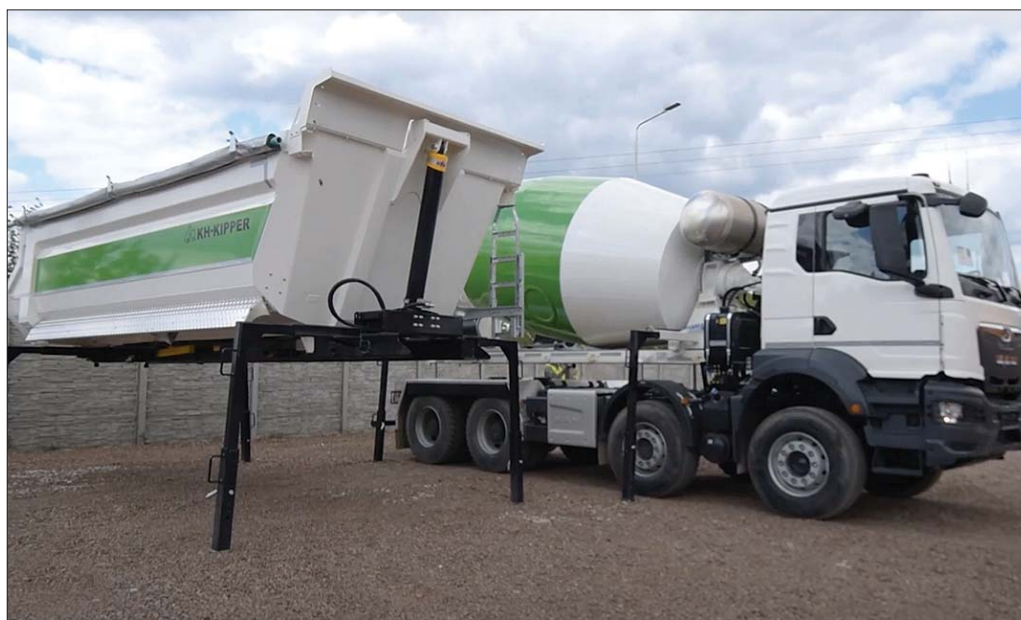
Oferowany przez KH-KIPPER tak zwany system wymienny jest rozwiązaniem zwiększającym funkcjonalność samochodu ciężarowego. Specjalny układ umożliwia wymienne stosowanie wszelkiego rodzaju zabudów montowanych na podwoziach ciężarowych
