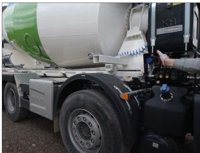
Całość operacji związanych z wymianą zabudowy może wykonać nawet jedna osoba, na przykład kierowca samochodu, w ciągu zaledwie 10-14 minut
