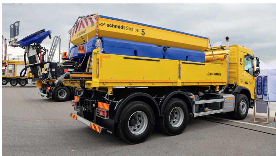
Do utrzymania dróg mogą być stosowane sól, chlorek wapnia, mieszanka piasku i soli, żwir oraz roztwory. Niebieskie zbiorniki na solankę są napelniane pompą ciśnieniową przez zawór lub od góry.
