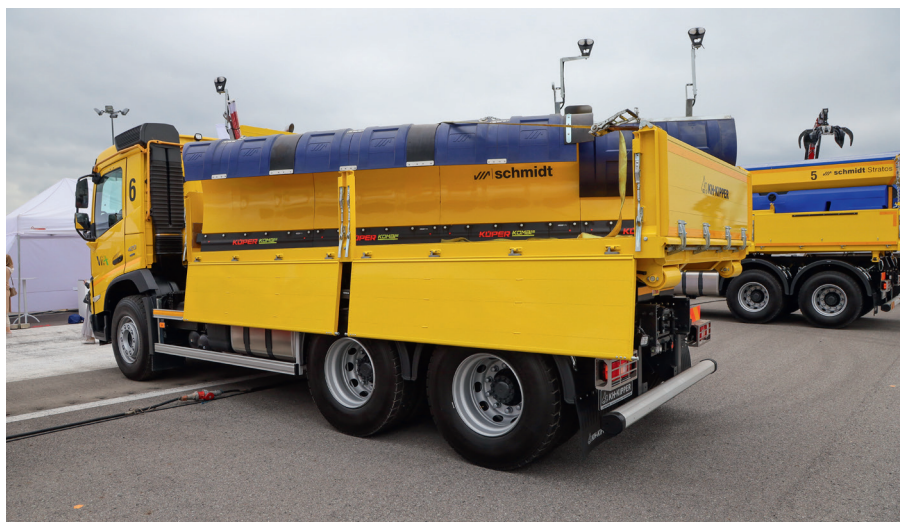
W obu skrzyniach zastosowano lekkie burty aluminiowe, łatwe do demontażu. Szybko i prosto zdejmują się także słupki, gdy trzeba przeładować za pomocą wózka widłowego długie elementy, jak choćby pług autostradowy.
