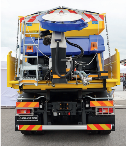
Posypywarki Stratos rozrzucają materiał na szerokość od 3 do 14 m, na ogół jest to 2-10 m. Konstrukcję podajnika i rozrzutnika tarczowego dobrano tak, by uzyskać maksymalnie jednolite pokrycie nawierzchni.
