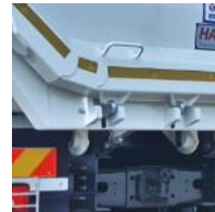
ochrona haków przed uszkodzeniem
