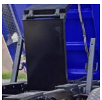
podpory naprawcze pod skrzynią ładunkową
