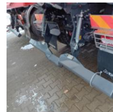
hydrauliczny lub manualny zderzak składany pod przyczepę
