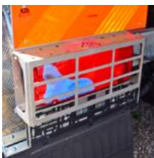
osłony świateł tylnych z uchyłną kratką
