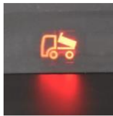
sygnalizacja podniesienia skrzyni w kabinie kierowcy
