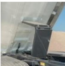
stabilizator nożycowy zapewniający bezpieczny rozładunek
