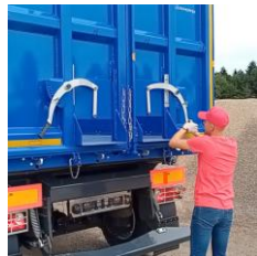
szybry umożliwiają precyzyjny wyładunek ziarna
