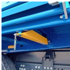
podpory naprawcze pod podłogą
