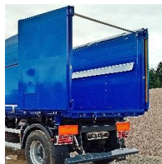
kłapo-drzwi pozwalają na załadunek innych materiałów na paletach
