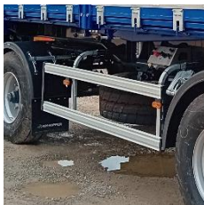
alumińowe boczne bariery przeciwnajazdowe
