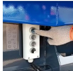
regulacja wysokości przyczepy
