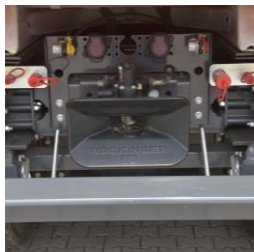
instalacja hydrauliczna do przyczepy
