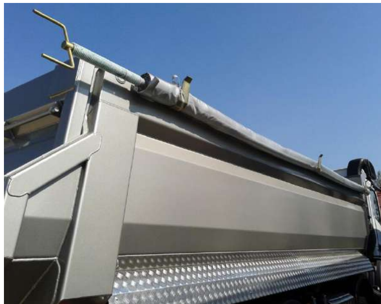
Rys. 32. Plandeka: a) zwijana na ścianę przednią, b) zwijana na burtę boczną
