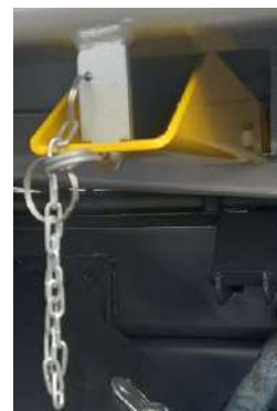
Rys. 2. Zawleczkę zabezpieczającą podporę naprawczą w wywrotce trójstronnej
