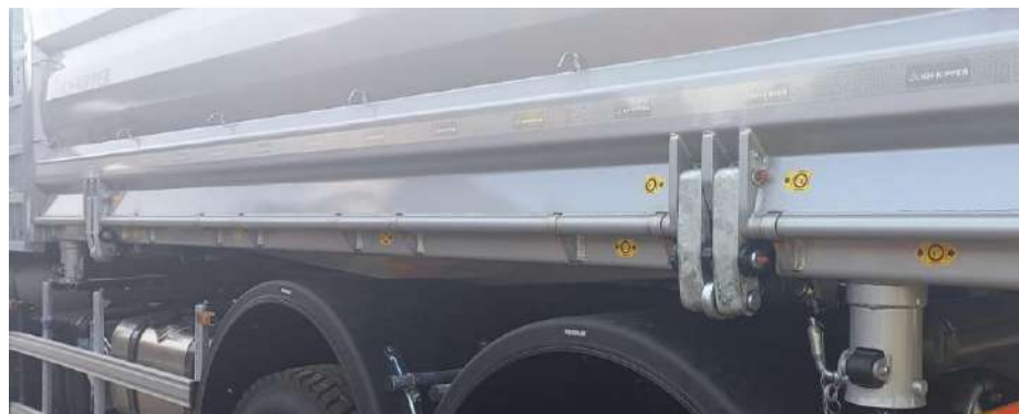
Rys. 1. Sworznie zabezpieczające zawiasy wywrotki trójstronnej
