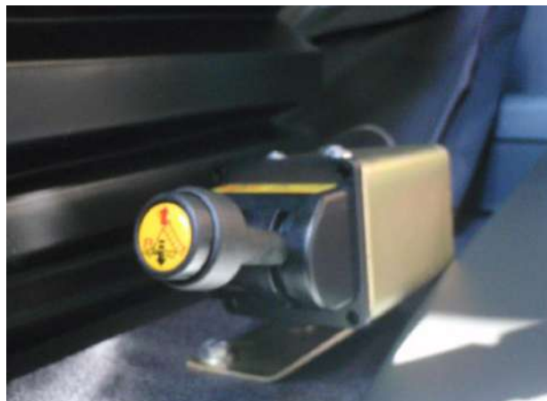
Rys. 9. Pneumatyczny zawór sterujący podnoszeniem i opuszczaniem skrzyni: a) podnoszenie skrzyni, b) opuszczanie skrzyni, c) pozycja neutralna
