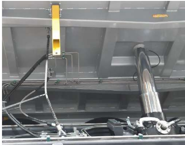
Rys. 7. Podniesiona skrzynia powyżej wysokości podpór naprawczych
