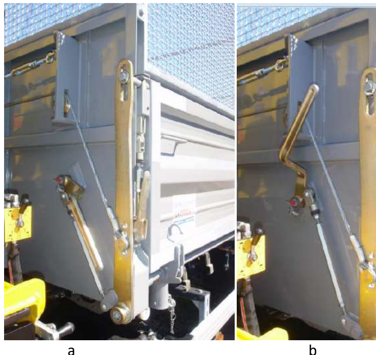
Rys. 22. Dźwignia burty bocznej: a) pozycja zamknięta, b) pozycja otwarta
