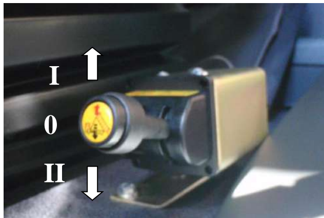
Rys. 19. Pneumatyczny zawór sterujący podnoszeniem i opuszczaniem skrzyni „I” - podnoszenie skrzyni; „0” - pozycja neutralna, „II” - opuszczanie skrzyni
