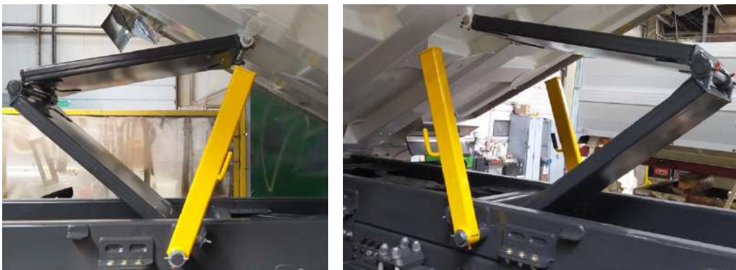
Rys. 3. Rozłożone podpory naprawcze
