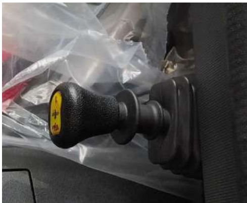
Rys. 1. Pneumatyczny zawór sterujący podnoszeniem i opuszczaniem skrzyni: a) pozycja neutralna, b) podnoszenie skrzyni
