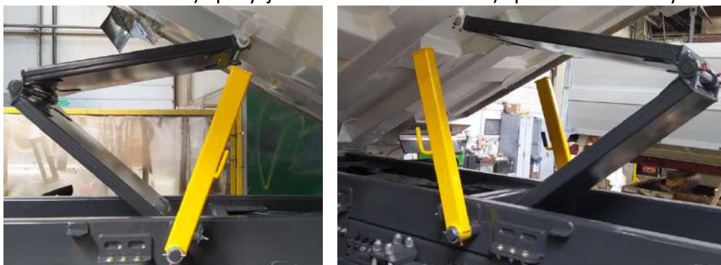
Rys. 8. Podniesiona skrzynia powyżej wysokości podpór naprawczych
