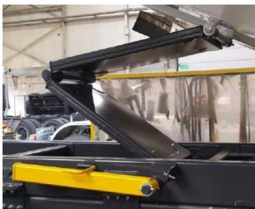
Rys. 2. Podniesiona skrzynia powyżej wysokości podpór naprawczych
