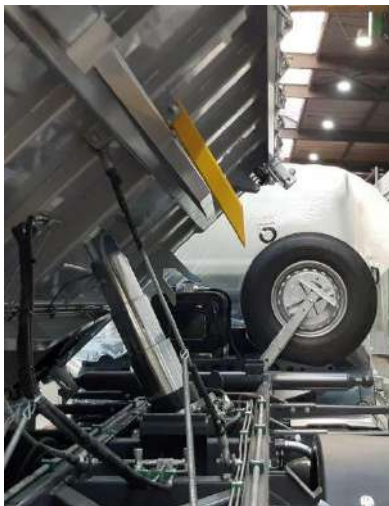
Rys. 7. Podniesiona skrzynia powyżej wysokości podpór naprawczych
