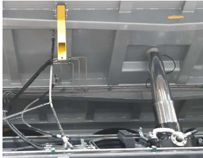
Rys. 2. Podniesiona skrzynia powyżej wysokości podpór naprawczych
