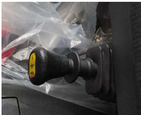
Rys. 11. Pneumatyczny zawór sterujący podnoszeniem i opuszczaniem skrzyni – pozycja neutralna
