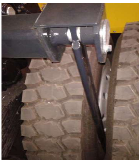
Rys. 45. Tylne osie z zamontowanymi ostrzami wyrzucającymi kamienie spomiędzy kół.
