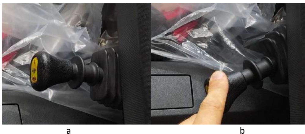
Rys. 10. Pneumatyczny zawór sterujący podnoszeniem i opuszczaniem skrzyni: a) pozycja neutralna b) opuszczanie skrzyni
