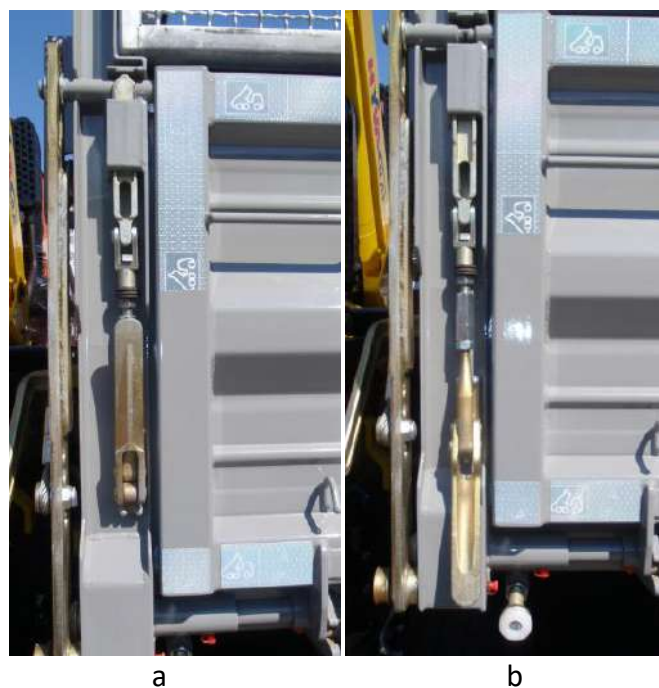
Rys. 23. Przykładowe zamknięcia burt bocznych. a) pozycja zamknięta, b) pozycja otwarta
