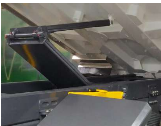
Rys. 2. Podniesiona skrzynia powyżej wysokości podpór naprawczych
