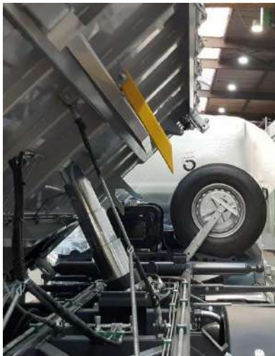
Rys. 2. Podniesiona skrzynia powyżej wysokości podpór naprawczych
