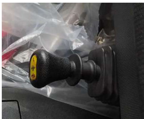
Rys. 6. Pneumatyczny zawór sterujący podnoszeniem i opuszczaniem skrzyni – pozycja neutralna
