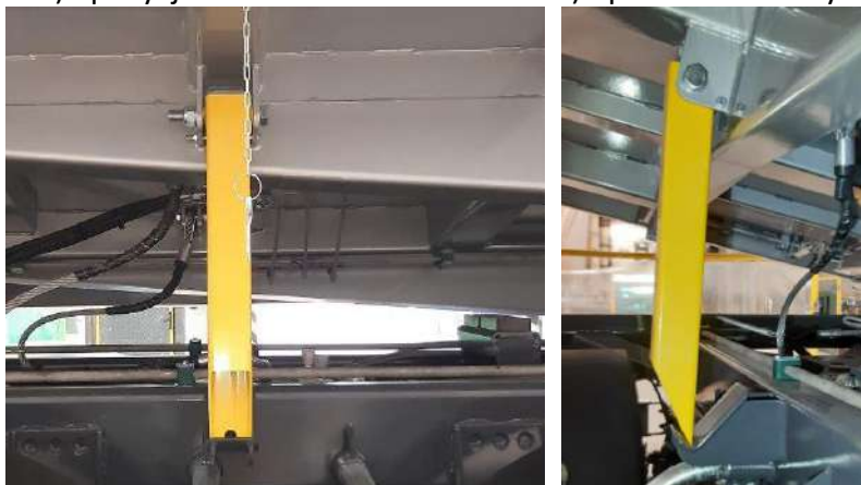
Rys. 4. Poprawnie rozłożona podpora naprawcza
