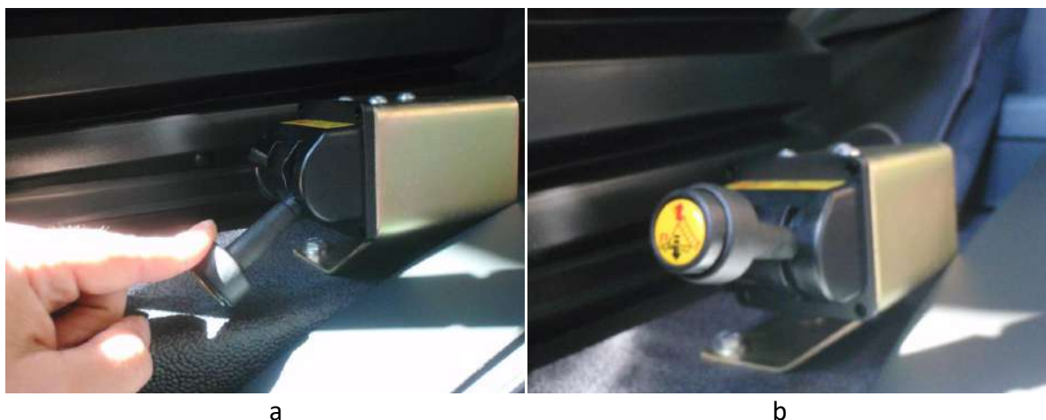
Rys. 26. Pneumatyczny zawór sterujący podnoszeniem i opuszczaniem skrzyni: a) opuszczanie skrzyni, b) pozycja neutralna
