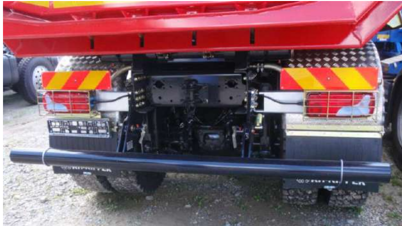
Rys. 41. Zderzak składany w pozycji opuszczonej
