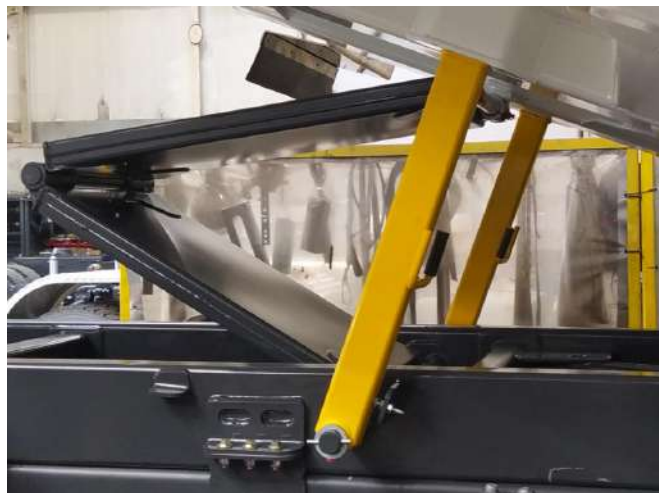
Rys. 5. Poprawnie rozłożona podpora naprawcza
