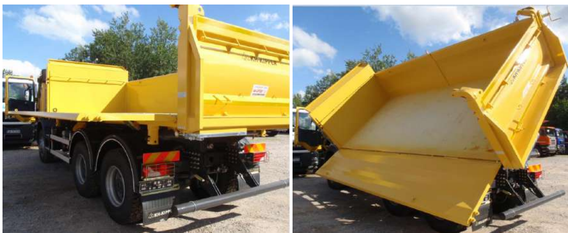
Rys. 20. Burta hydrauliczna otwarta do wyładunku materiałów sypkich
