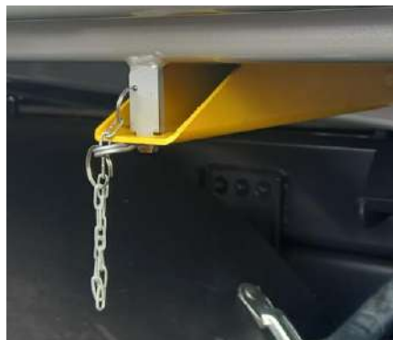
Rys. 2. Zawleczkę zabezpieczającą podporę naprawczą w wywrotce trójstronnej
