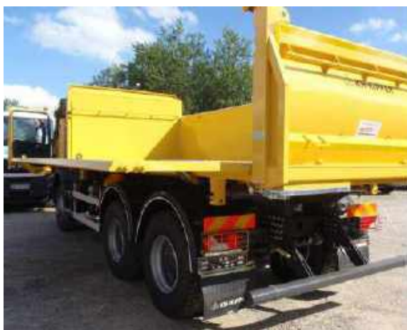
Obr. 18. Otevřená hydraulická bočnice pro vykládku sypkých materiálů
