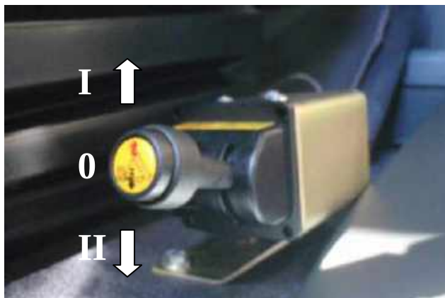
Obr. 15. Pneumatický ventil ovládající zvedání a spouštění korby: „I” – zvedání korby; „0” – neutrální poloha; „II” – spouštění korby
