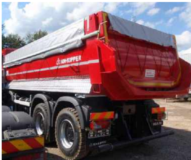
Obr. 35. Správě rozložená plachta
