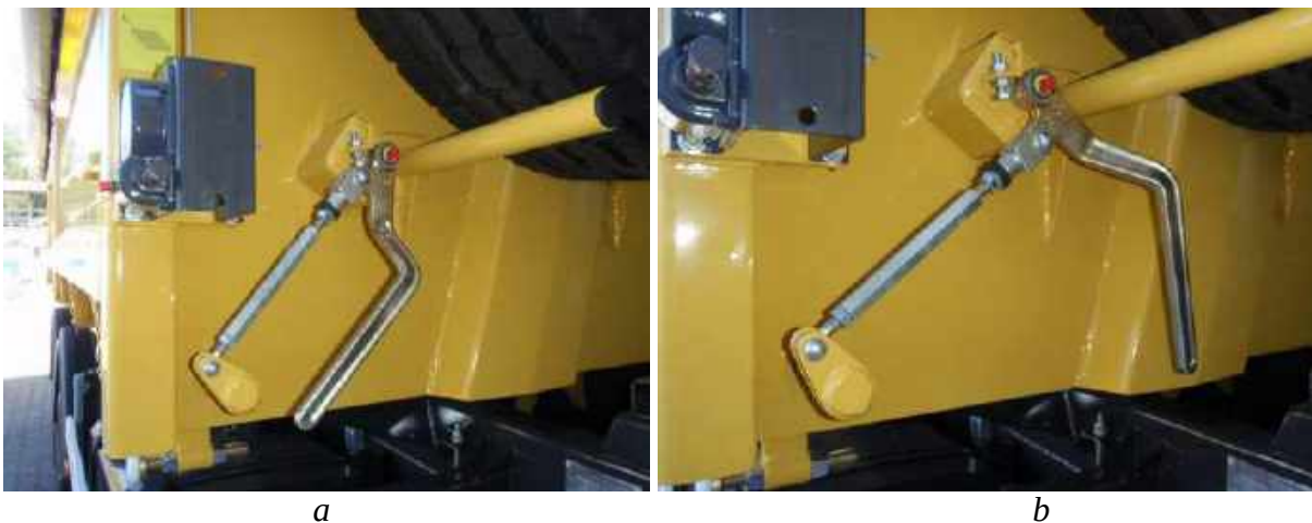
Obr. 11. Páka otevírající/zavírající háky bočnic: a) zavřená poloha, b) otevřená poloha
