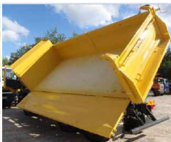
Obr. 18. Otevřená hydraulická bočnice pro vykládku sypkých materiálů
