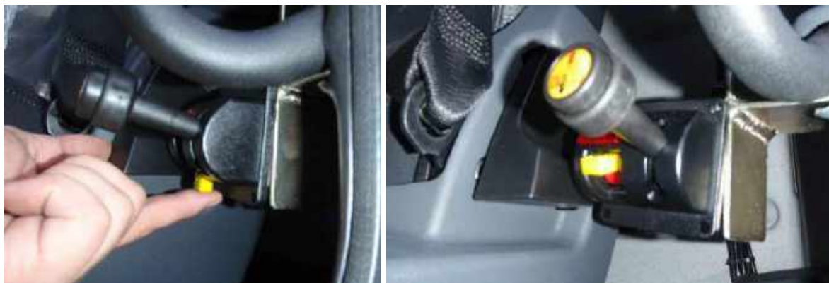
Obr. 12. Otvírání zadního čela přepínačem integrovaným s ovladačem zvedání korby
