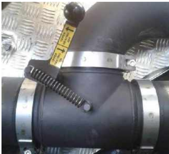
Obr. 40. Ventil rozdělující spaliny
