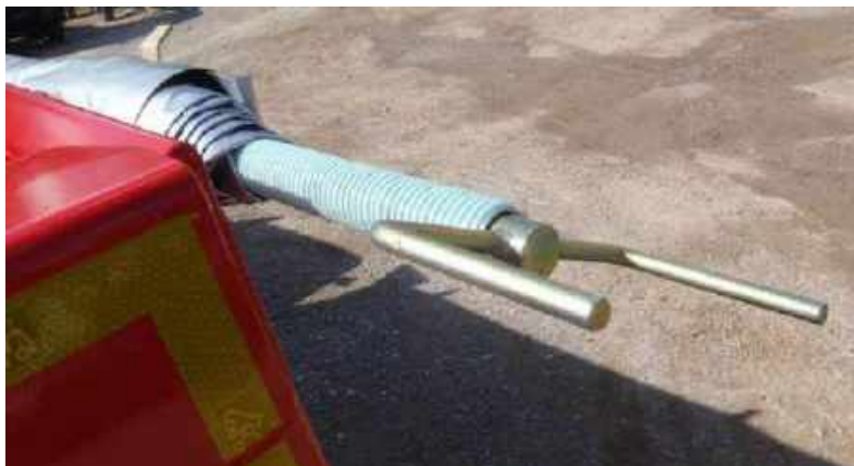
Obr. 34. Klika plachty stahované do strany
