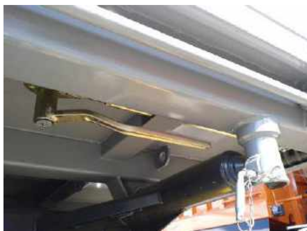
Obr. 10. Páka otevírající/zavírající háky zadního čela: a) zavřená poloha, b) otevřená poloha
