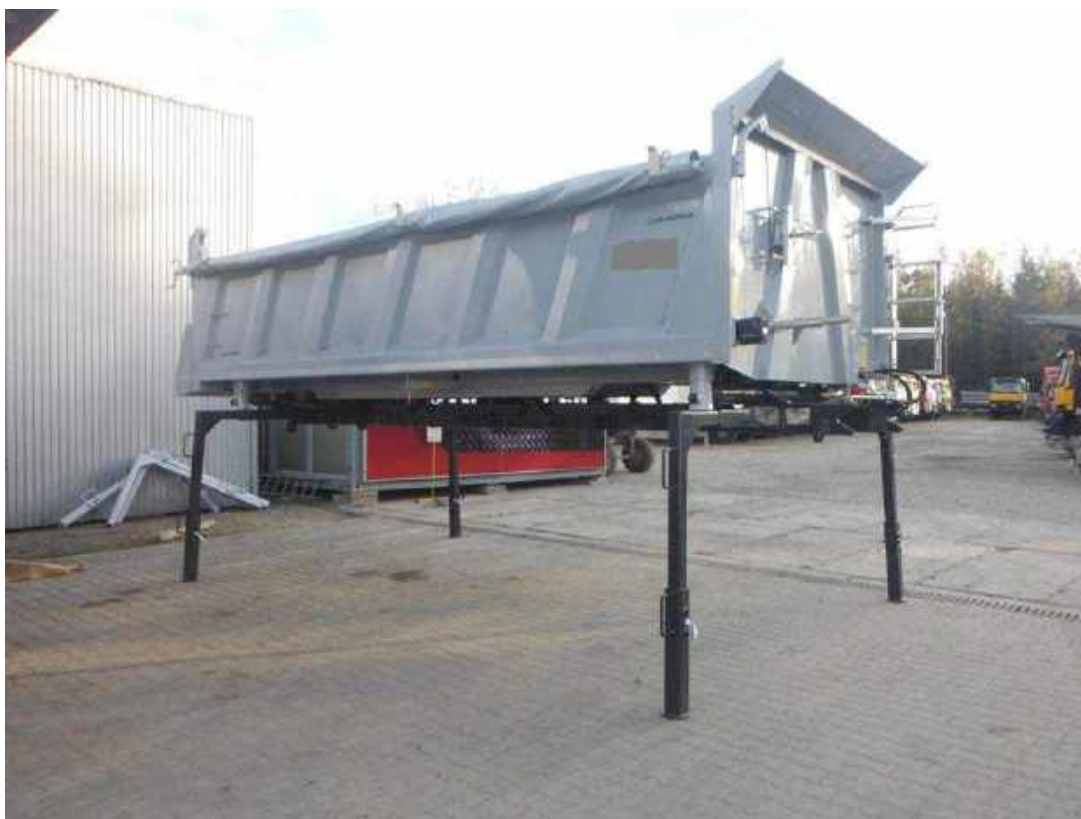
Obr. 44. Korba sklápěčky na bočních podpěrách
