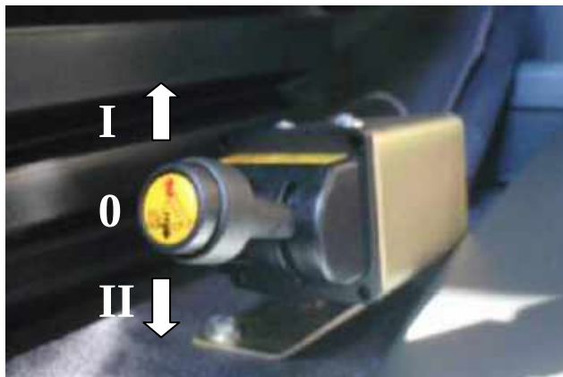
Obr. 23. Pneumatický ventil ovládající zvedání a spouštění korby: „I“ – zvedání korby; „0“ – neutrální poloha; „II“ – spouštění korby
