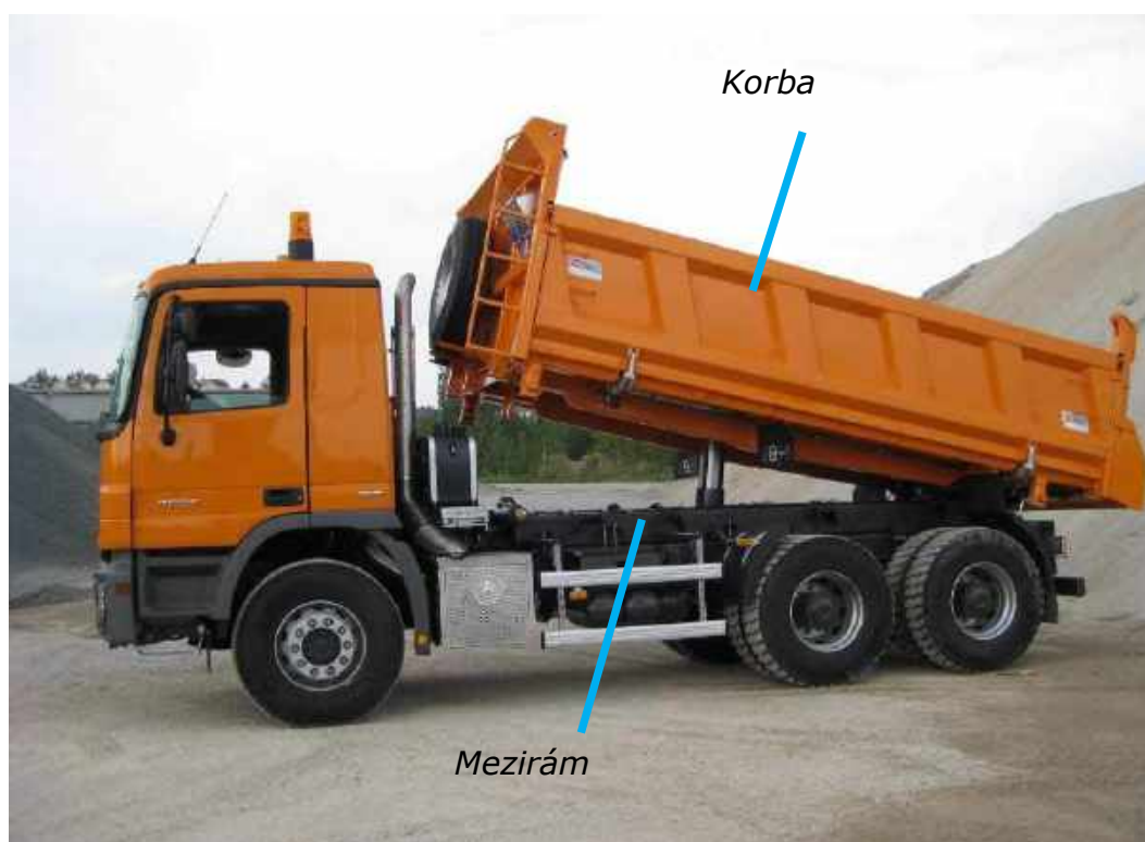
Obr. 1. Příkladová nástavba – sklápěčka
