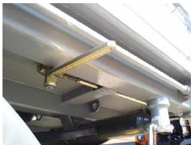
Obr. 10. Páka otevírající/zavírající háky zadního čela: a) zavřená poloha, b) otevřená poloha
