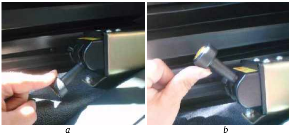
Obr. 13. Pneumatický ventil ovládající hydraulickou bočnici nebo zadní čelo: a) otevírání bočnice nebo zadního čela, b) zavírání bočnice nebo zadního čela
