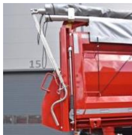
Nach Bedienung ist Kurbel gesichert
